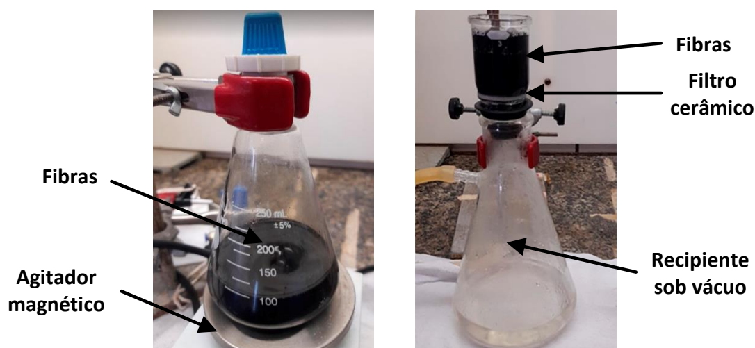
Figura 36 – Funcionalização das fibras micrométricas de carbono. a) Agitação em solução de acetona e GLYMO. b) Lavagem com filtração
