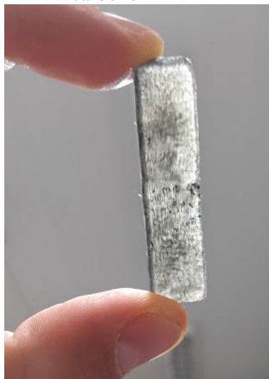
Figura 61 – Corpo de prova de flexão impresso com alinhamento das fibras micrométricas de carbono
