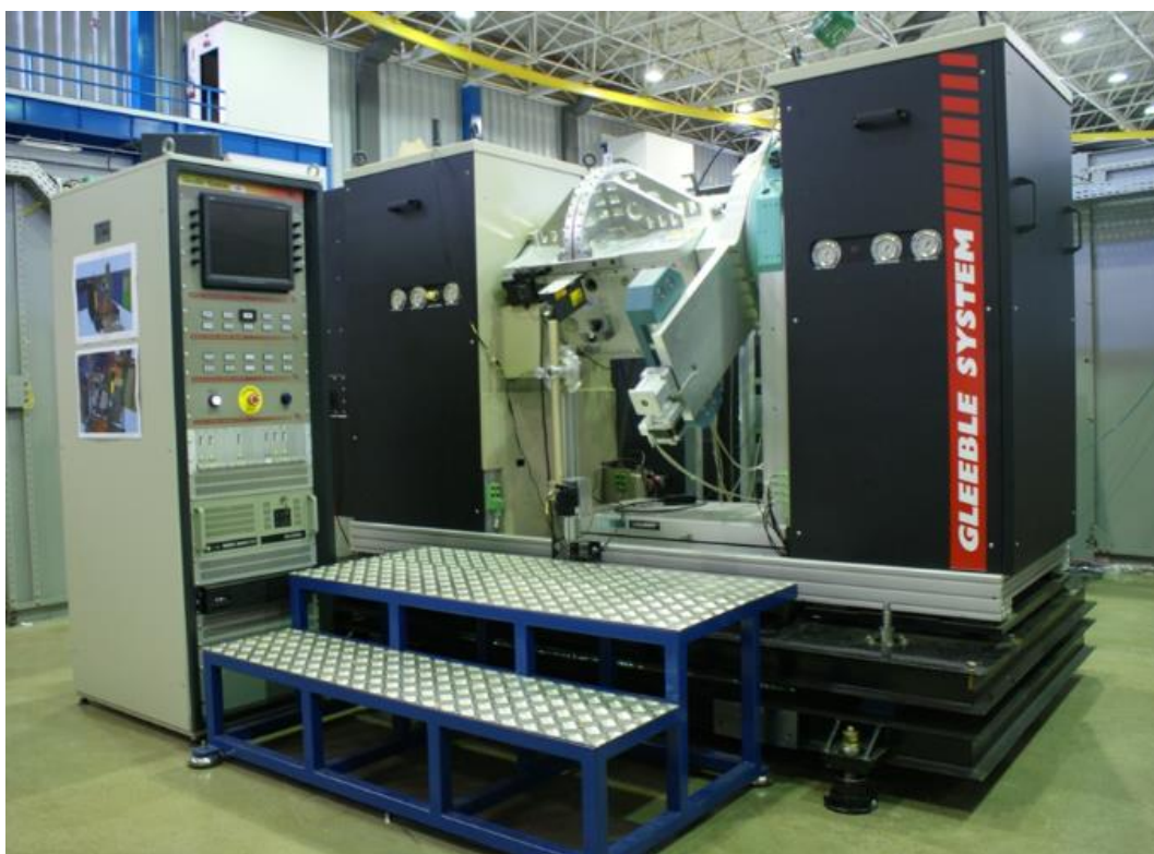
Figura 4-6. Linha XTMS para realização dos ensaios de aquecimento com difração de raio-X in-situ.
