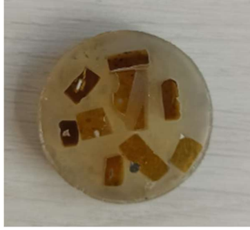
Figura 16. Amostra preparada para análise por MEV/EDS [Próprio do autor].
