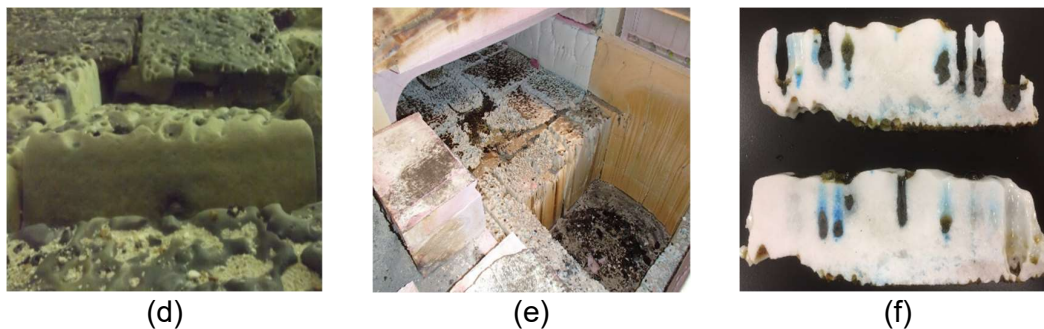
Figura 12. (a) Perfuração na sola do forno devido à contaminação metálica [36]. (b) Esfera de silício causando trincas [fonte própria]. (c) Contaminação de sulfeto de cobre em embalagem de vidro [36]. (d) a (f) Efeito de contaminações metálicas em refratários de fornos [fonte Owens Illinois].
