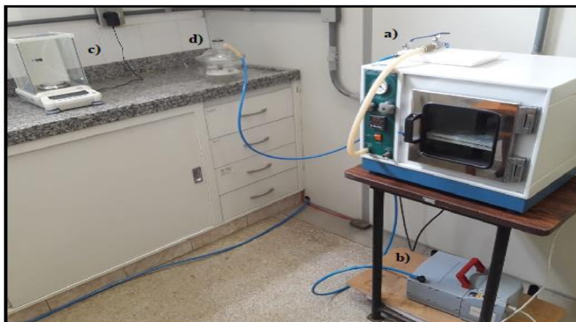
Figura 28 - Sistema utilizado para a saturação das amostras, sendo composto por: a) estufa, b) bomba de vácuo, c) balança analítica e d) dessecador utilizado como uma câmara de vácuo.
