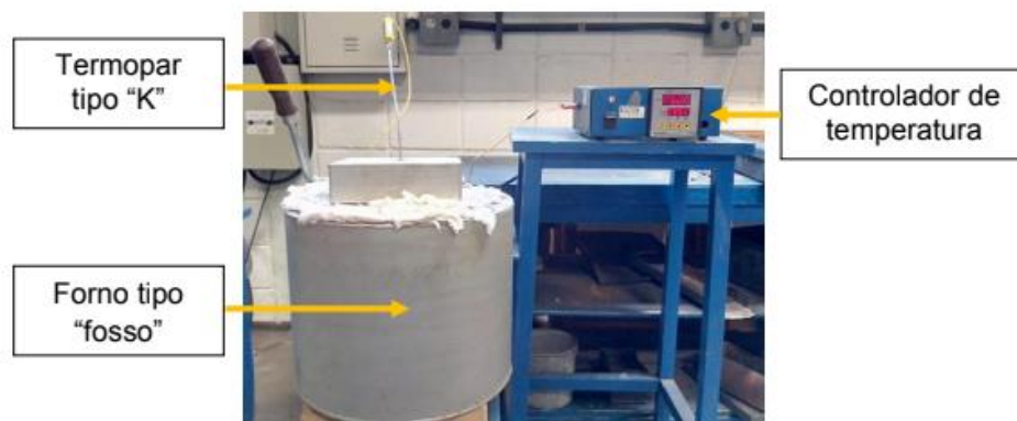
Figura 18 - Sistema usado no tratamento termoquímico de boretação.
