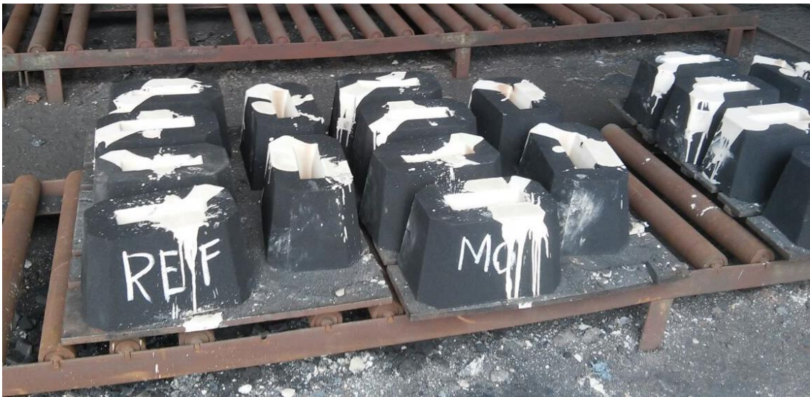
Figura 8 – Molde de areia para fundição
