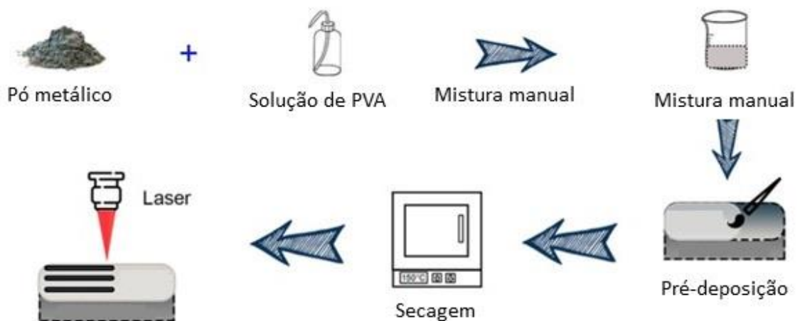
Figura 6 - Esquema de funcionamento da técnica de laser cladding (Bartkowski et al., 2018)
