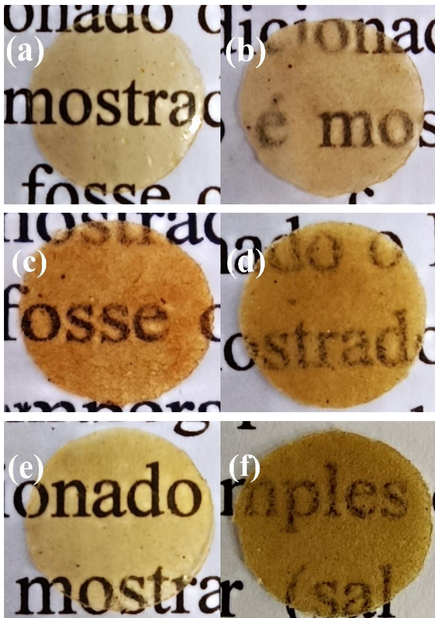
Figura 30 - Filmes de quitosana obtidos pelo processo de solução: a) Qui-Sol, e por termocompressão: b) Qui-TC, c) Qui-Gli, d) Qui(DES-G), e) Qui (DES-AC) e f) Qui(ChCl-Pol).
