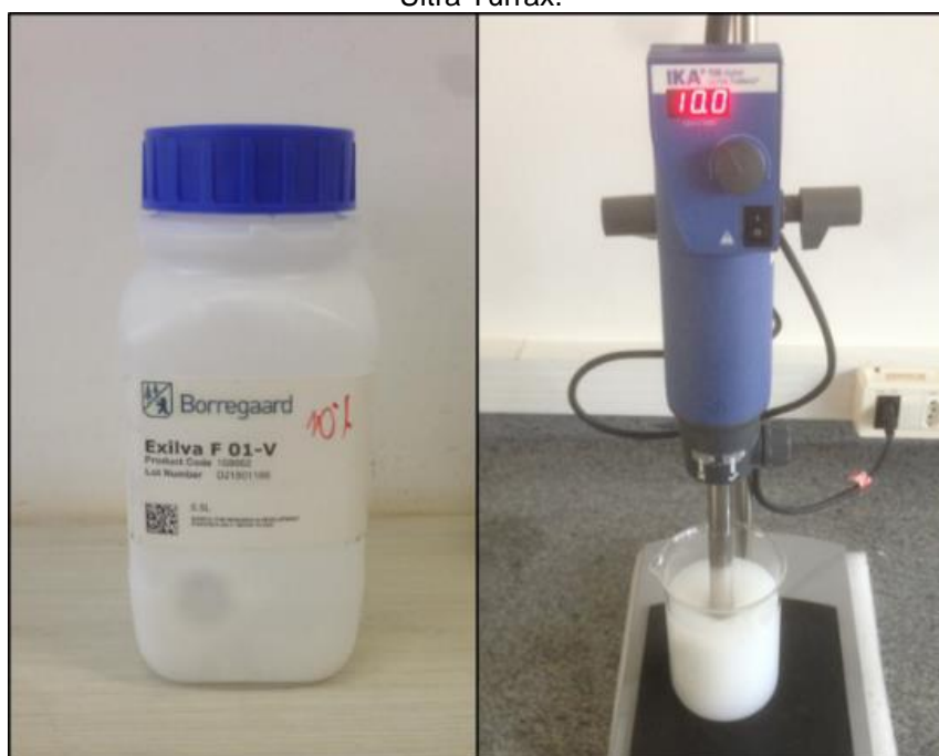
Figura 10 – a) Exilva F 01-V com 10%p/p de MFC; b) preparação de dispersão aquosa de MFC no Ultra Turrax.
