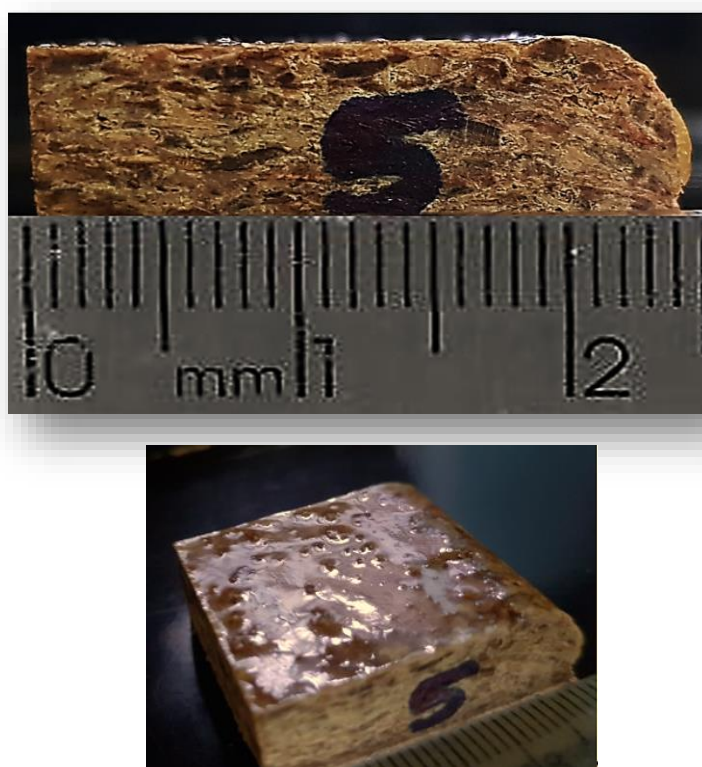
FIGURA 33 – Perfil e Superfície do corpo-de-prova de PPHM M5 utilizado para o ensaio de Reflectância telha revestido com resina de Mamona.
