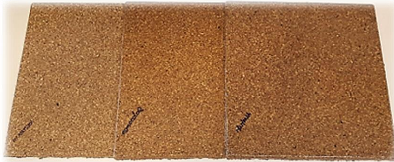
FIGURA 15 – Da esquerda para a direita: Painel de PPH sem revestimento; Painel de PPH revestido com Osmocolor; e Painel de PPH revestido com Mamona.
