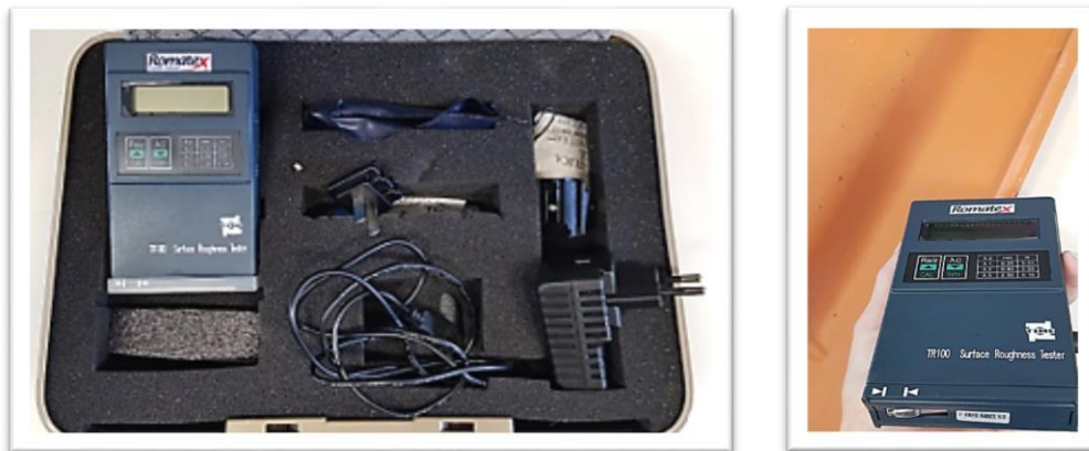
FIGURA 25 – Equipamento Romatex digital, utilizado para medir a rugosidade das telhas de PPHM e da telha cerâmica. Fonte: Arquivo próprio, 2018
