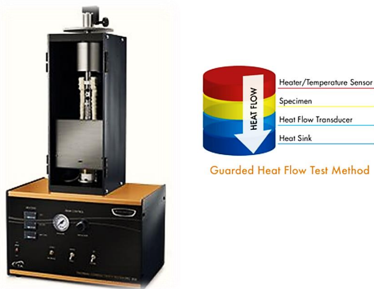
FIGURA 24 – Thermal Conductivity Tester DTC – 300; e passagem do fluxo de calor descendente pelo corpo-de-prova.
