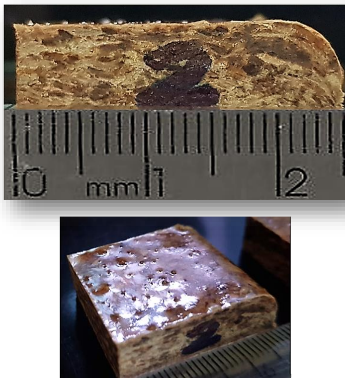
FIGURA 30 – Perfil do corpo-de-prova de PPHM M2 utilizado para o ensaio de Reflectância telha revestido com resina de Mamona.
