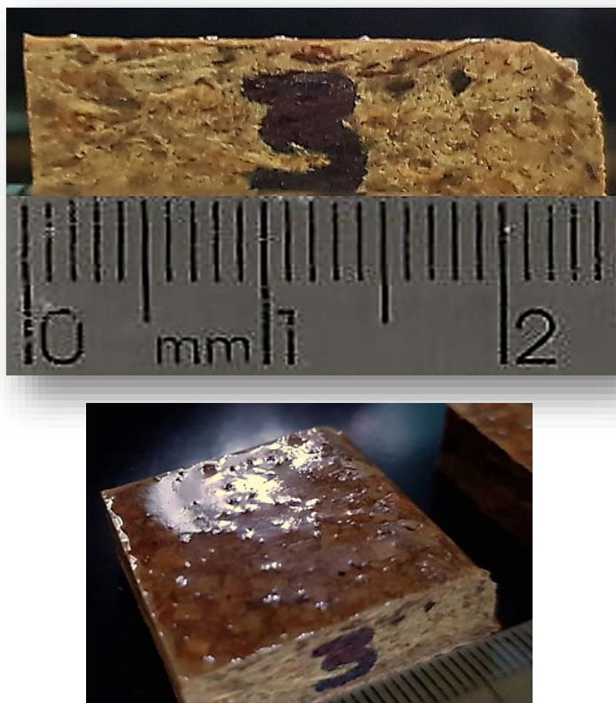
FIGURA 31 – Perfil e Superfície do corpo-de-prova de PPHM M3 utilizado para o ensaio de Reflectância telha revestido com resina de Mamona.
