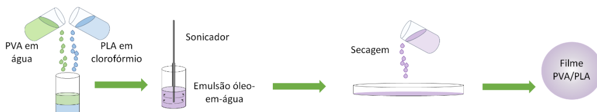
Figura 14: Esquema de preparação das blendas de PVA/PLA pelo método de emulsão.
