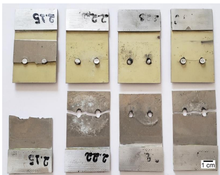
Figura 33 – Corpos de prova Al-GI fraturados.
