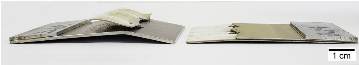
Figura 36 – Grande flexão da placa não-escareada GI-AI 3.24.
