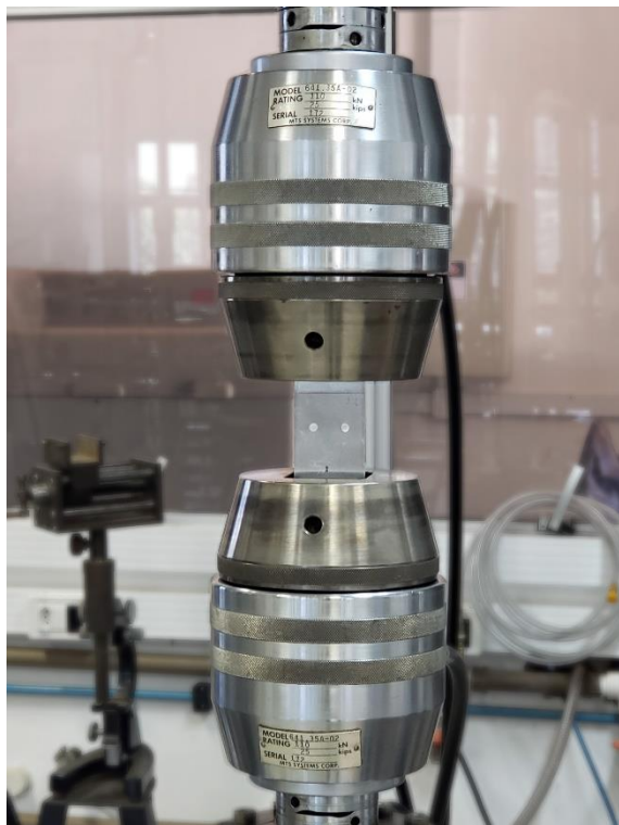
Figura 15 – Fixação dos corpos de prova na máquina de ensaios.
