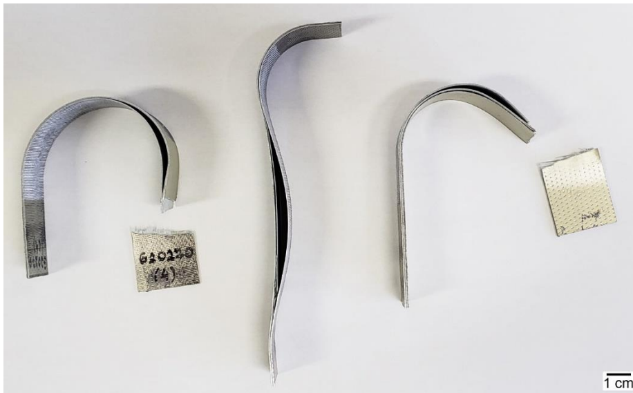
Figura 37 – Amostras de Glare com diferentes configurações após ensaio de tração.
