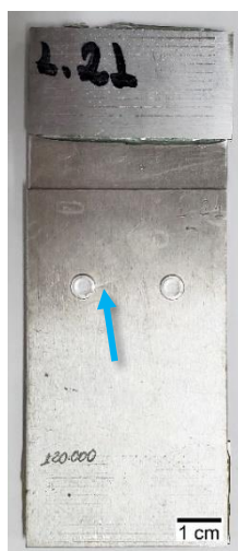
Figura 29 – Corpo de prova Al-Al 1.21 após a 3ª rodada de ensaios de fadiga.
