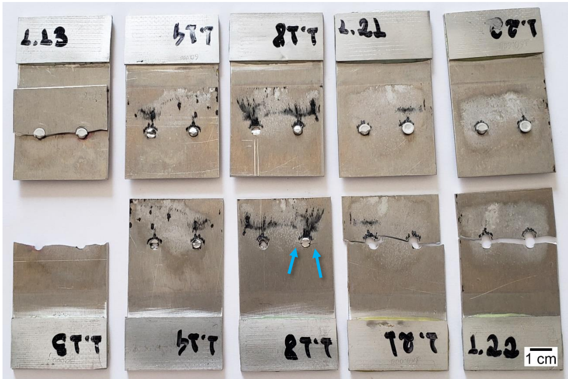
Figura 30 – Corpos de prova Al-Al fraturados.
