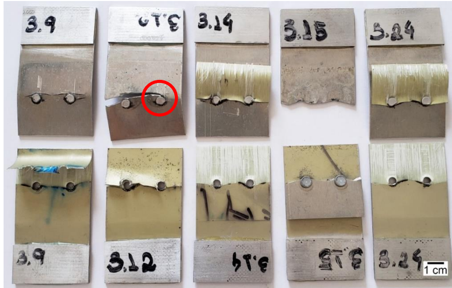
Figura 34 – Corpos de prova GI-Al fraturados.
