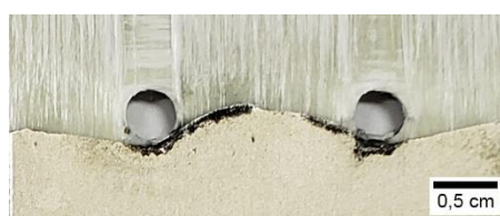
Figura 35 – Região entre os rebites do corpo de prova GI-Al 3.24 fraturado
