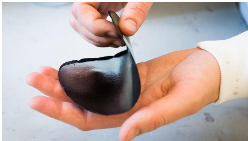
Figura 2.9: Compósito a partir de PEDOT:PSS, nanofibras de celulose, glicerol e dimetilsulfóxido para armazenagem de energia. Acessado em [42]
