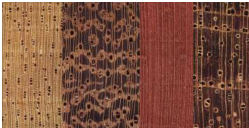
Figura 4 – Microestruturas de madeiras de árvores Dicotiledôneas, Angiospermas
