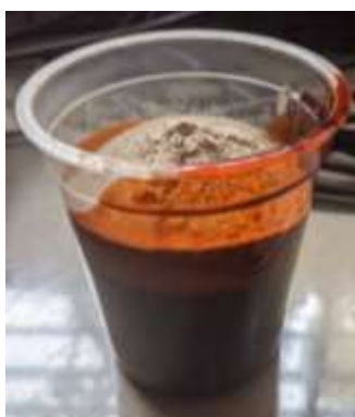
Figura 9 - Aspecto físico do adesivo Cascophen RS-216-M
