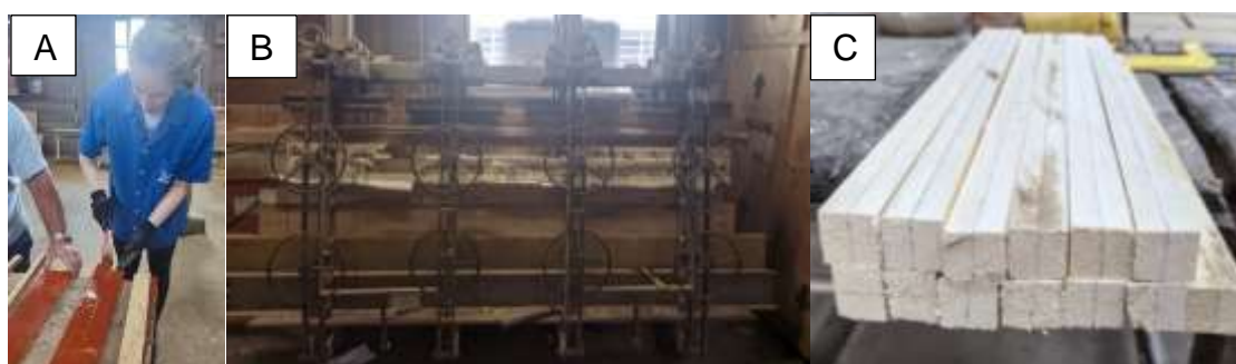
Figura 11 - Adesivo e montagem dos elementos de MLC
