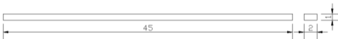
Figura 6 - Dimensões finais das lamelas (cm)
