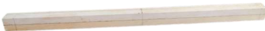
Figura 20 - Corpo de prova de Marupá
