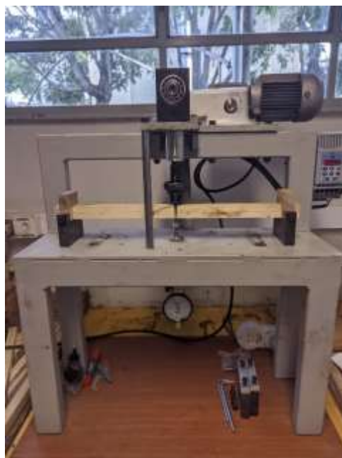
Figura 13 - Máquina de ensaios cíclicos
