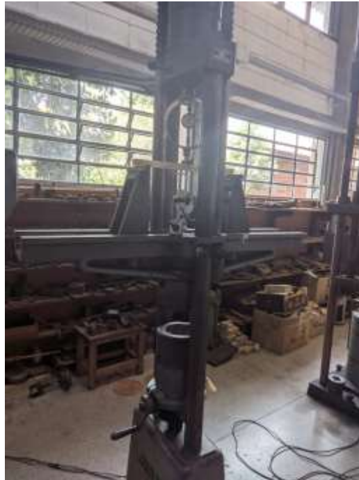
Figura 12 - Máquina de ensaio universal AMSLER
