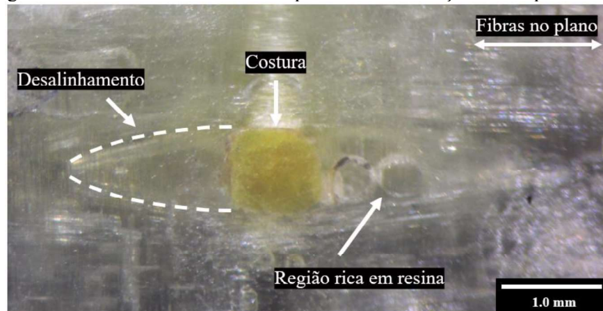
Figura 34 - Desalinhamento causado pelo feixe de reforço em compósitos 3D.
