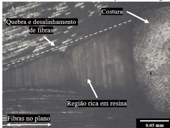
Figura 35 – Quebra e desalinhamento de fibras causados pela costura e regiões ricas em resina.
