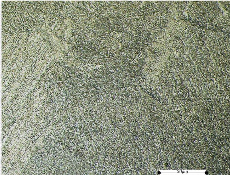
Figura 64 - Tamanho de grão pré-austenítico (PAGS) referente a amostra Dr: obteve classificação 2, segundo a norma ASTM E1120 e método de interceptação Reyen.
