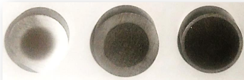
Figura 27 - Exemplos de profundidade da camada (área mais clara) obtida com o mesmo indutor, mas diferentes parâmetros de frequência e densidade de potência [21].
