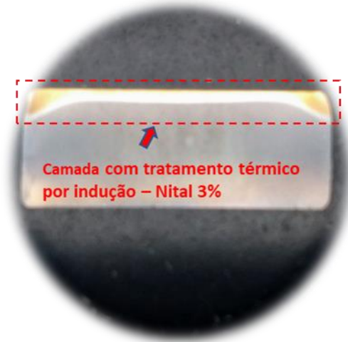
Figura 41 - Aspecto da amostra após tratamento térmico superficial por indução.
