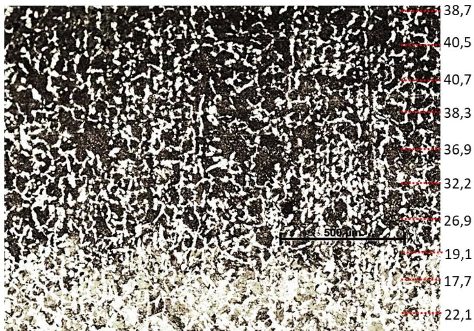
Figura 52 - Aspecto da camada da amostra BNr – nital 3%, espessura alcançada, 0,77mm e dureza na superfície igual a 40,6 HRC.
