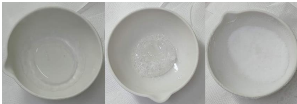
Figura 5 – Fotografia representando a 1ª fase: Produção do fosfato de gálio – adição de H_3PO_4 , Ga_2O_3 e nitrogênio líquido, macerados até o ponto de homogeneização.
