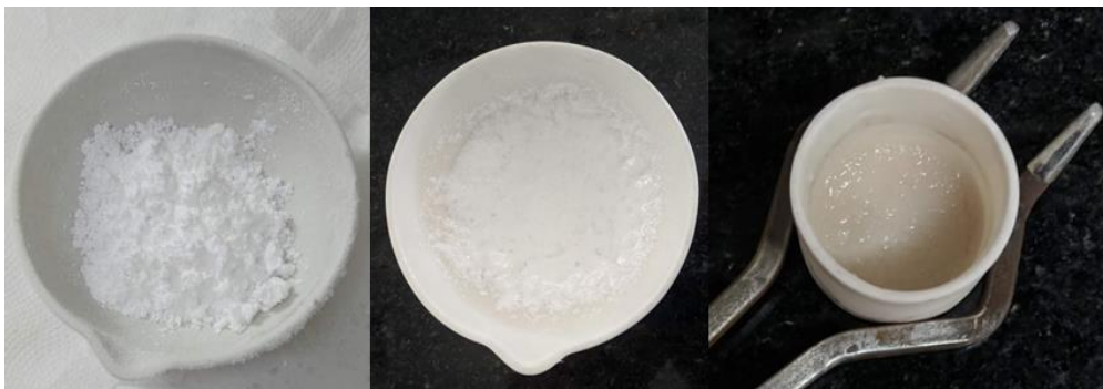
Figura 6 – Fotografia demonstrando a 2° fase: Maceração - homogeneização dos compostos - resfriamento - exposição a temperatura ambiente – e 1° tratamento térmico do fosfato de gálio.
