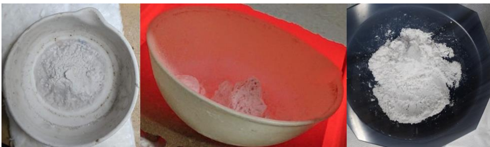
Figura 7 – Fotografia representando o 3° fase: 2° tratamento térmico do fosfato de gálio - período de resfriamento - maceração do reagente pronto para uso na produção das matrizes.
