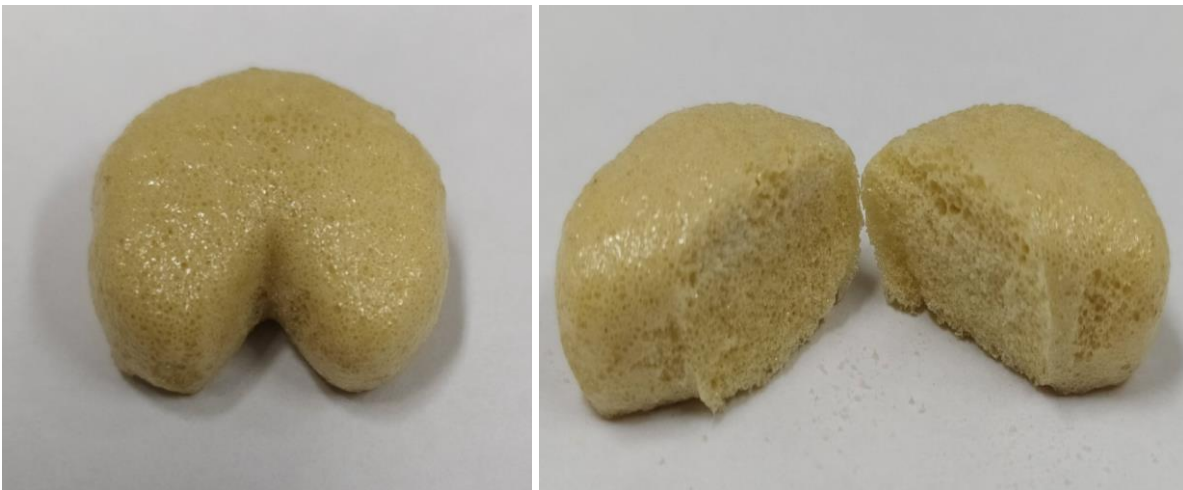
Figura 41: Peças de vidro impressas tratadas termicamente à 800 °C.
