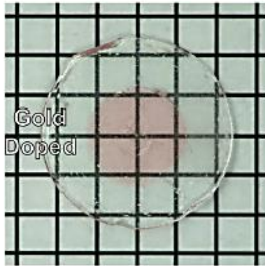
Figura 3: Peça de sílica vítrea com gradiente composicional. No centro, região colorida dopada com ouro.
