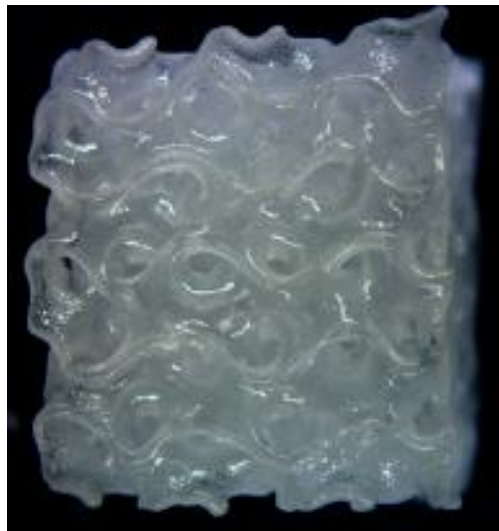
Figura 12: Scaffold translúcido produzido com vidro LCD por processamento digital de luz.
