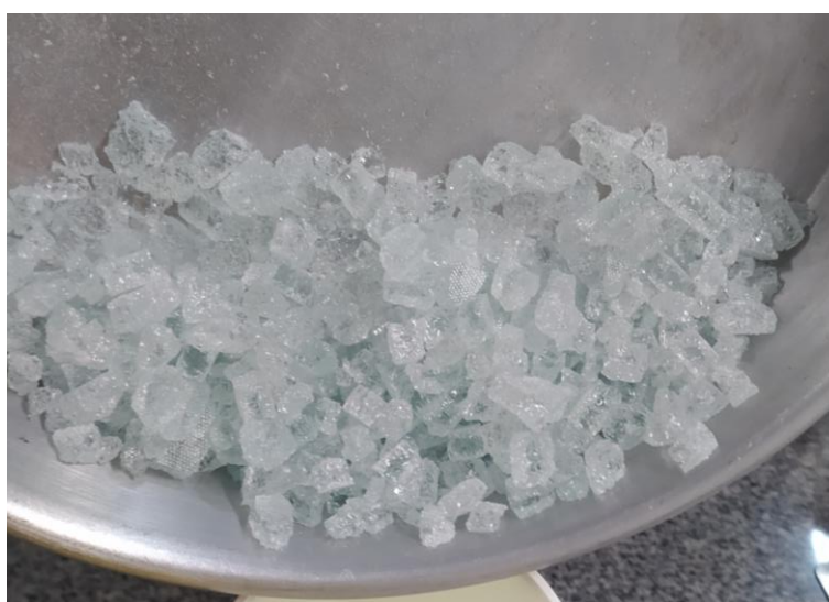
Figura 21: Fragmentos da placa obtidos após choque térmico e britagem manual.
