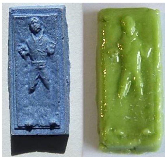
Figura 2: Peças de vidro impressas por extrusão: à esquerda com partículas de 700 nm e à direita com partículas de 50 \mu\text{m}
