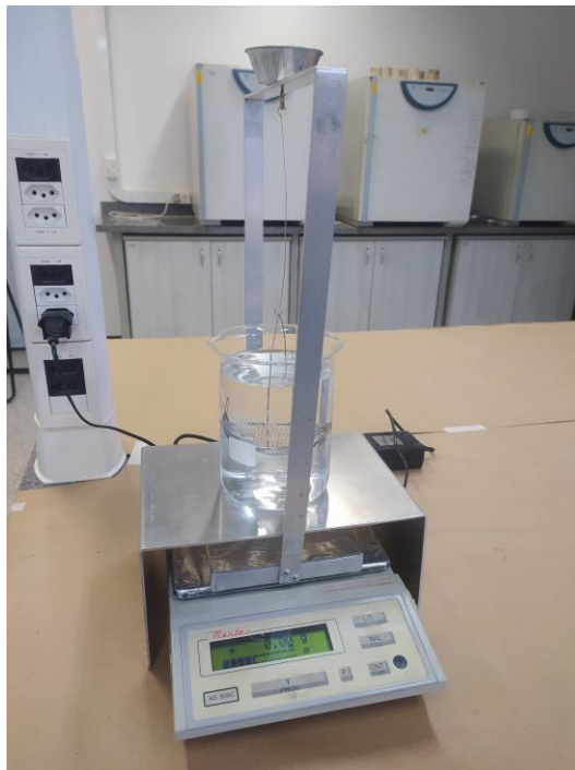
Figura 25: Aparato para medição da densidade pelo Princípio de Arquimedes
