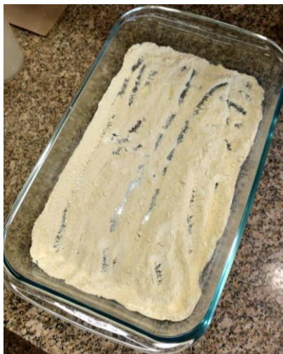
Figura 3.1 – PZT em pó sintetizado pelo método de Pechini (método dos precursores poliméricos), antes de ser submetido à moagem em moinho de bolas.
