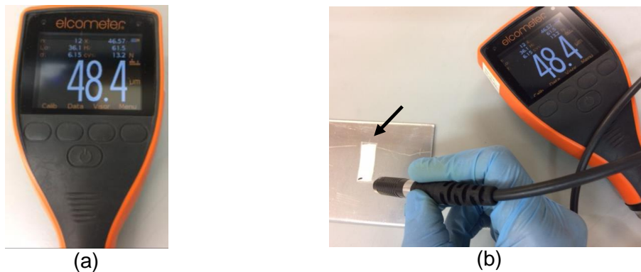
Figura 3.6 – Medição das espessuras dos filmes flexíveis com dispositivo Elcometer®, sendo: (a) detalhamento do medidor de espessura e (b) medição da espessura de amostra de filme flexível de compósito SNaPZT3 (indicado pela seta).
