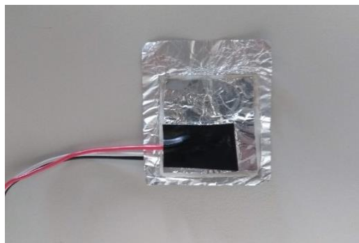
Figura 5.7 – Sensor com eletrodos de papel alumínio colados com tinta-prata
