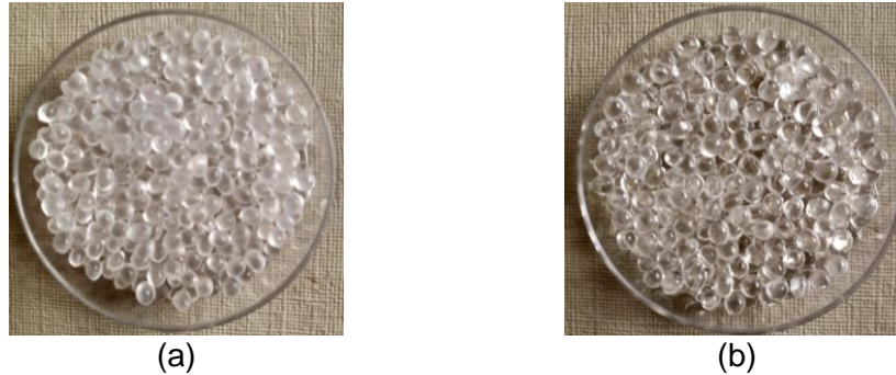
Figura 3.3 – Ionômeros do tipo Surlyn® em pellets comercializado pela DuPont™, sendo: (a) Surlyn® 8940 (SNa0) e (b) Surlyn® 9320 (SZn0).
