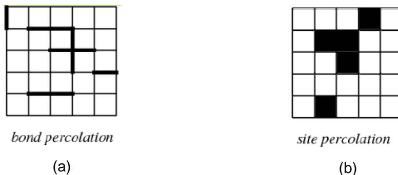
Figura 5.1 – Representação esquemática dos tipos de percolação, segundo a teoria de percolação discreta, sendo: (a) percolação “ bond ” e (b) percolação “ site ”.
