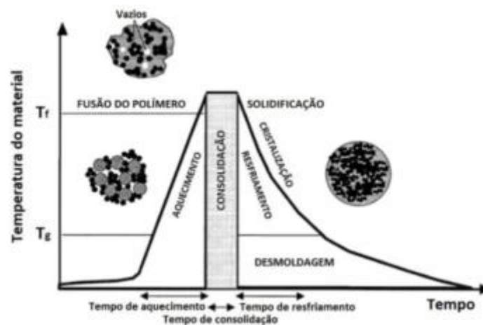
Figura 9 - Etapas do processamento por moldagem por compressão a quente.
