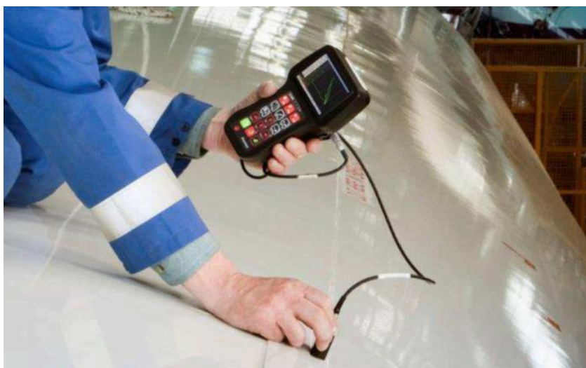
Figura 31 – Ensaio por correntes parasitas aplicado na fuselagem da aeronave.
