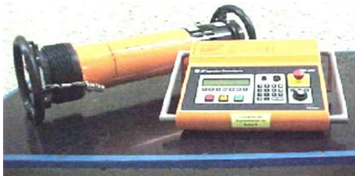
Figura 34 - Equipamento de raios-X convencionais (por filmes) empregado neste estudo.
