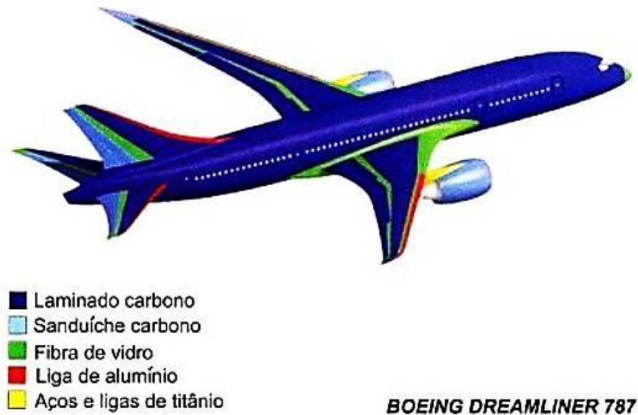
Figura 10 - Utilização de materiais de construção na aeronave Boeing Dreamliner.
