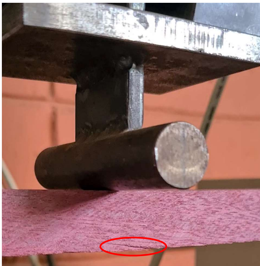
Figura 20 – Corpo de prova de Roxinho com fissura
