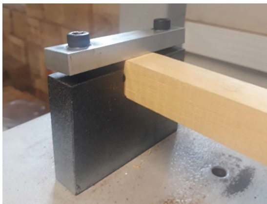
Figura 8 – Apoio do corpo de prova na máquina de fadiga
