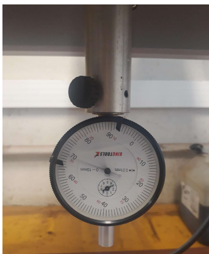
Figura 11 – Relógio comparador instalado na parte inferior do equipamento
