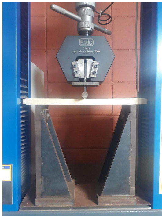
Figura 13 – Corpo de prova posicionado para ensaio na EMIC
