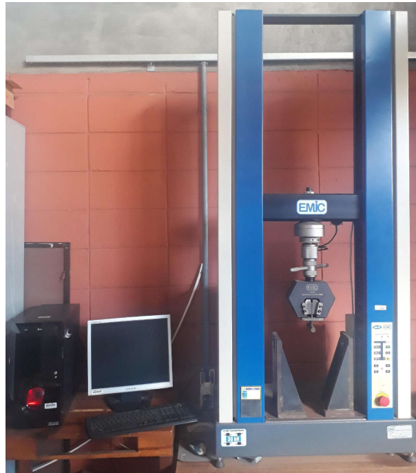
Figura 12 – EMIC e computador instalado para a leitura dos dados ensaiados pela máquina
