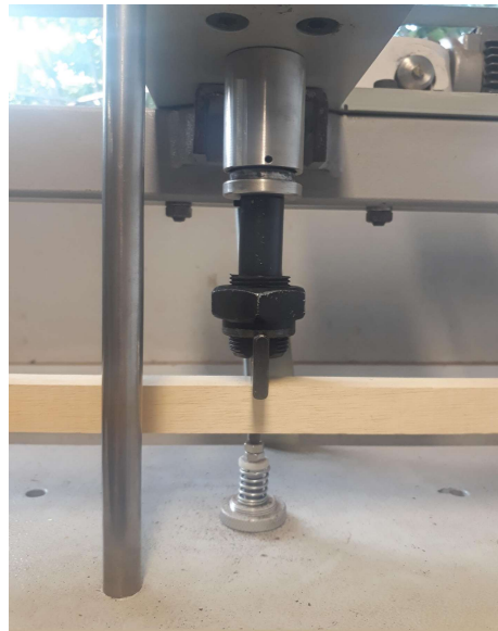
Figura 9 - Esquema com parafuso e porca para ajuste do deslocamento aplicado no corpo de prova
