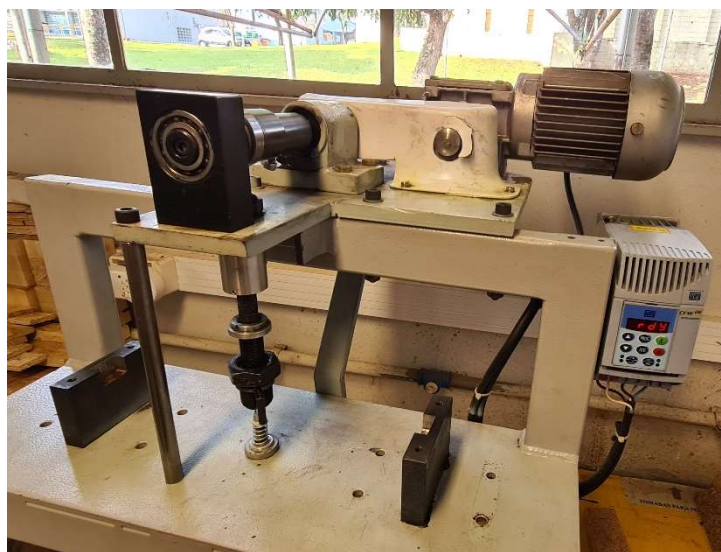
Figura 7 – Máquina de simulação de fadiga
