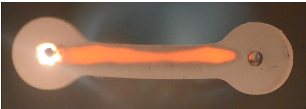
Figura 81 – Início do aquecimento por passagem de corrente elétrica.
