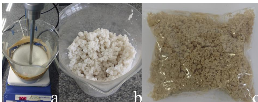
Figura 15- Mistura MFC-copolímero (a) durante o processo de mistura mecânica; (b) durante o processo de secagem em estufa e (c) após completar o processo de secagem.
