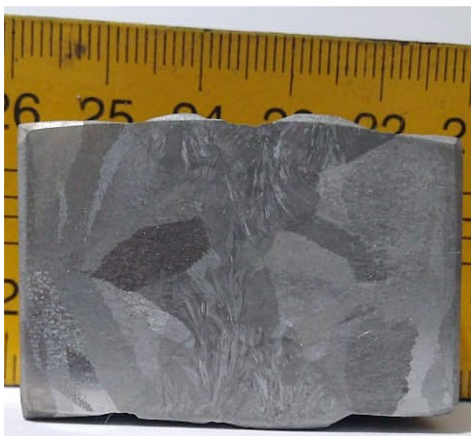
Figura 61: Macrografia da junta soldada na condição bruta de fusão.
