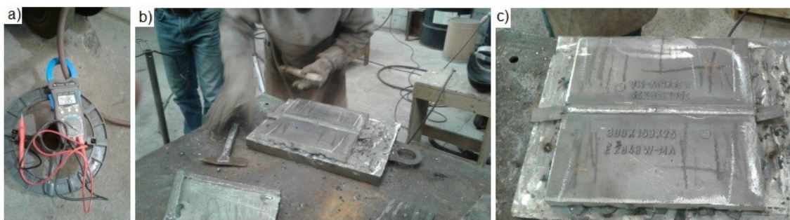
Figura 41: Execução da soldagem das placas. (a) Medição da corrente de soldagem. (b) Execução de limpeza entre passes. (c) Junta soldada finalizada.
