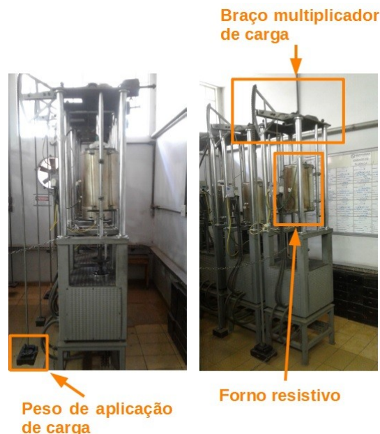
Figura 51: Equipamento do tipo “peso morto” utilizado para a execução dos ensaios de fluência.
