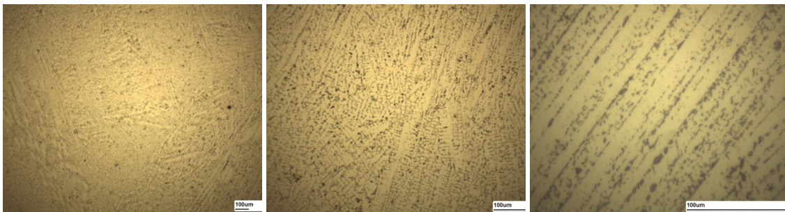
Metal de solda, ampliação 50x
