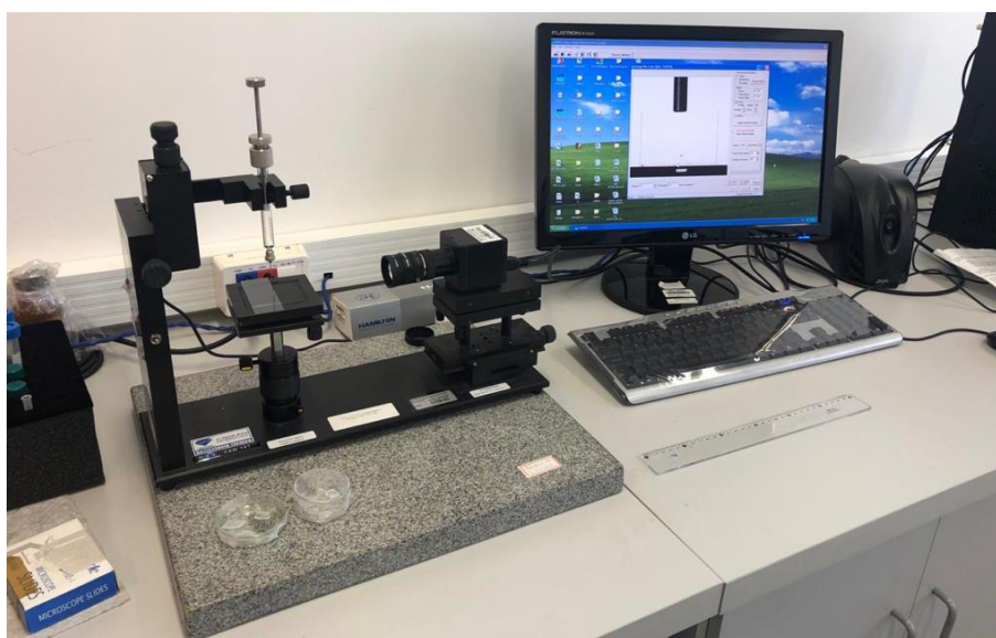
Figura 18: Configuração do goniômetro utilizado nos experimentos
