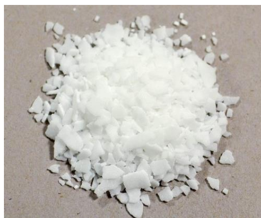
Figura 7: Estrutura química do ácido esteárico (esq.) e sua forma utilizada (dir.)
