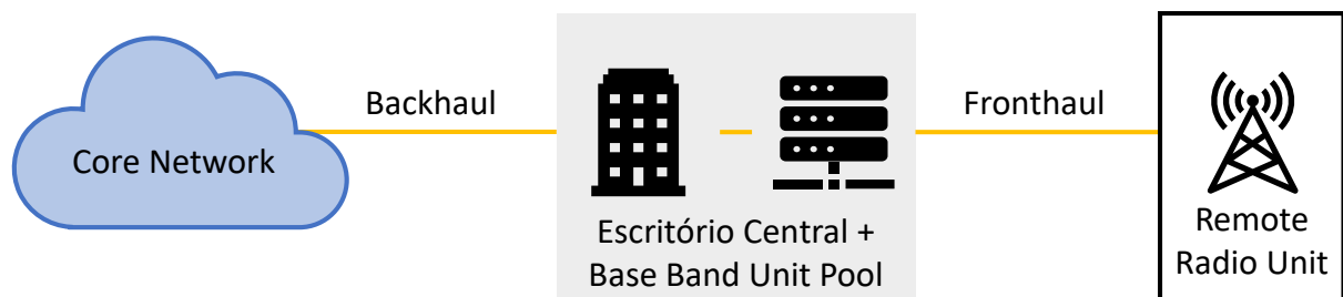
Figura 3 – Esquemático simplificado de uma arquitetura de rede 5G.
