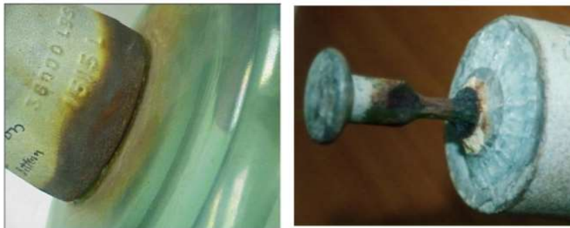
Figura 40 – Corrosão em Isoladores de Vidro. Fonte: [4]
