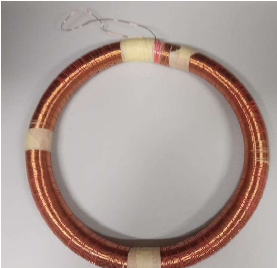
Figura 3.8 – Bobina de Rogowski para monitoramento da corrente de fuga.
