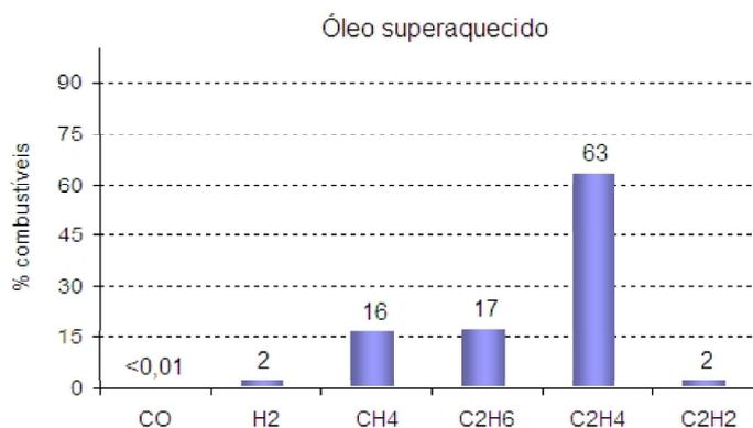
Figura 5.18: Composição dos gases pela ocorrência de superaquecimento no óleo. [19]
