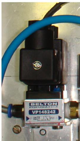
Figura 8.10: Válvula pneumática - Belton VP148242. [30]
