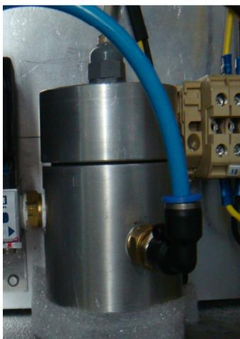
Figura 8.8: Câmara para análise dos gases livres.
