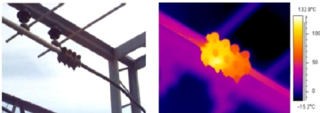
Figura 5.3: Ponto quente na conexão do barramento de alta tensão. [14]
