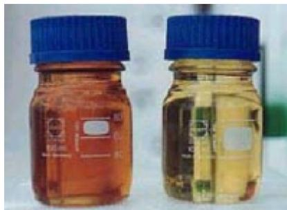
Figura 2.1: Amostras de óleo isolante com diferentes tonalidades. [1]
