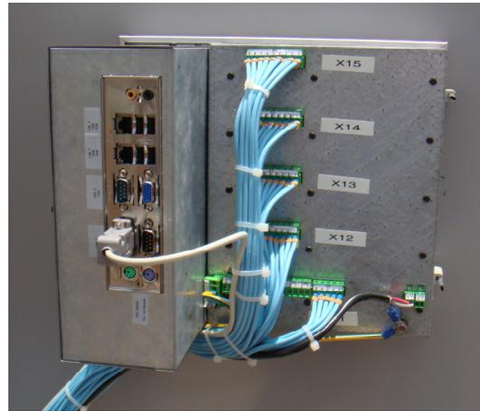
(b) Fiação e pontos de conexão de interfaces.
