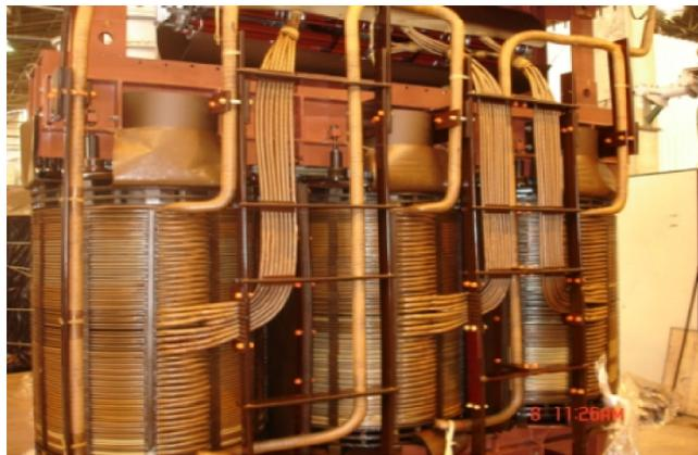
Figura 2.5: Núcleo de um transformador com isolação sólida feita por papel.
