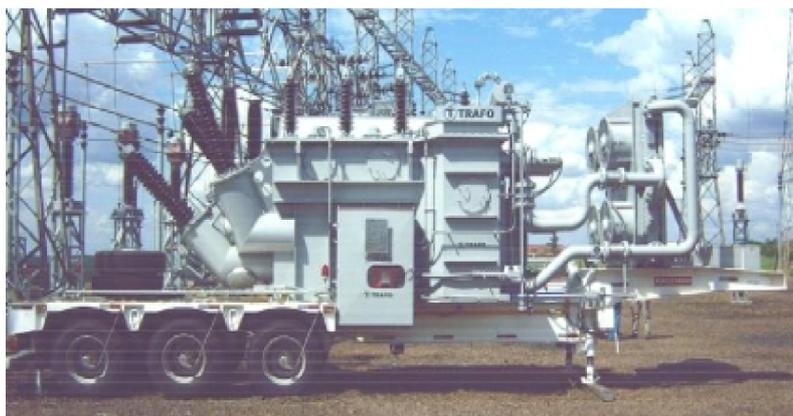
Figura 5.28: Auto-transformador móvel de 36,6 MVA - 138-69 kV.
