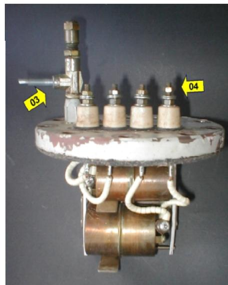
(b) 3-Registro para coleta de gases e 4-Conexões elétricas externas.
