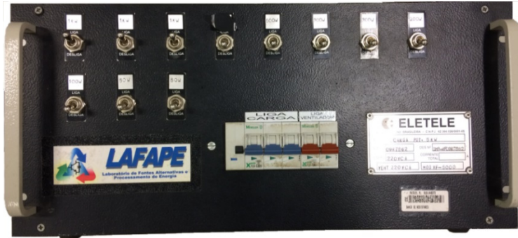
Figura A.2.4 – Carga local ajustável de 50W a 5kW.
