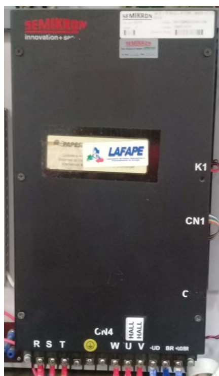
Figura A.1: Inversor da bancada experimental.
