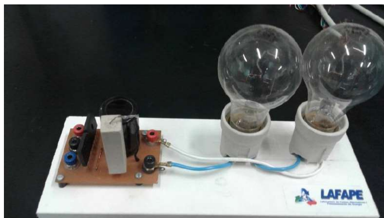
Figura 5.16: Carga não linear - retificador trifásico não controlado.
