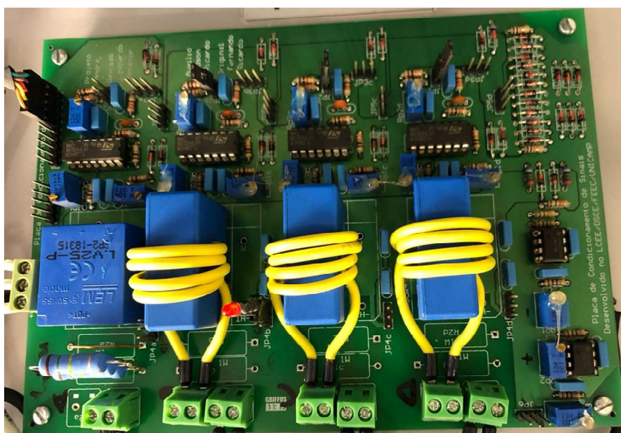
Figura A.5: Placa de condicionamento de sinal – Corrente.
