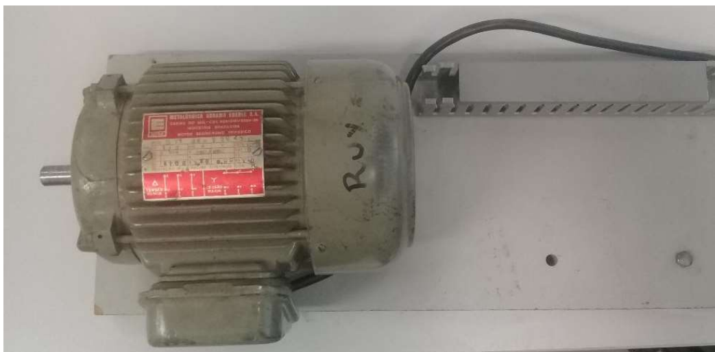
Figura 5.18: Carga indutiva – Motor de Indução Trifásico (visão geral).
