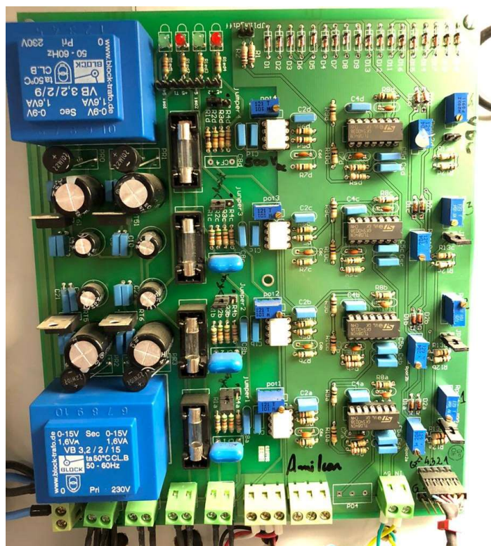
Figura A.6: Placa de condicionamento de sinal – Tensão.
