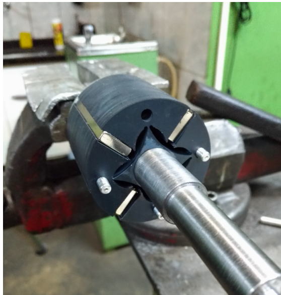
(c) Vista do interior do rotor durante montagem.
