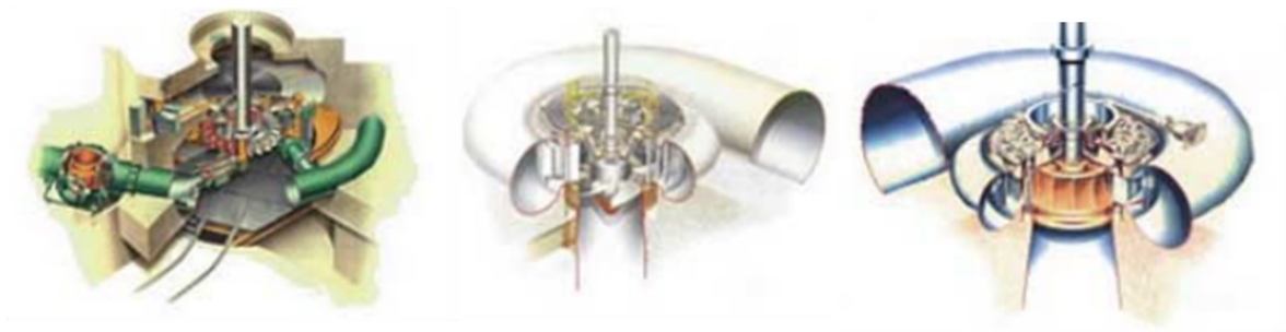
Figura 6: Turbinas Pelton, Kaplan e Francis, respectivamente
