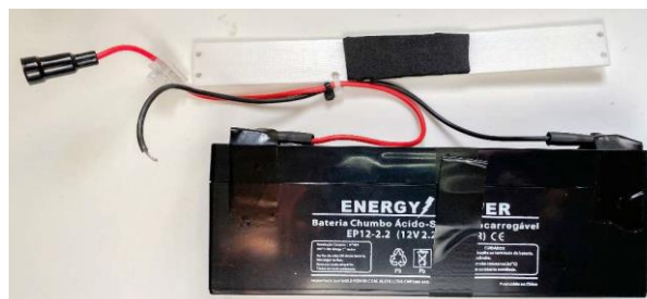
Figura 5.10: Bateria pronta para a conexão.
