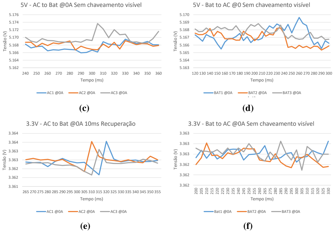
Figura 5.16: Gráfico mostrando todas as comutações entre as fontes: (a) Comutação entre AC e bateria em 12V com 0A, (b) Comutação entre bateria e AC em 12V com 0A, (c) Comutação entre AC e bateria 5V com 0A, (d) Comutação entre bateria e AC em 5V com 0A, (e) Comutação entre AC e bateria em 3.3V com 0A, (b) Comutação entre bateria e AC em 3.3V com 0A .
