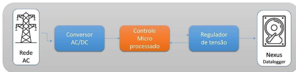
Figura 3.1: Visão geral simplificada da fonte ilustrando as três funções.
