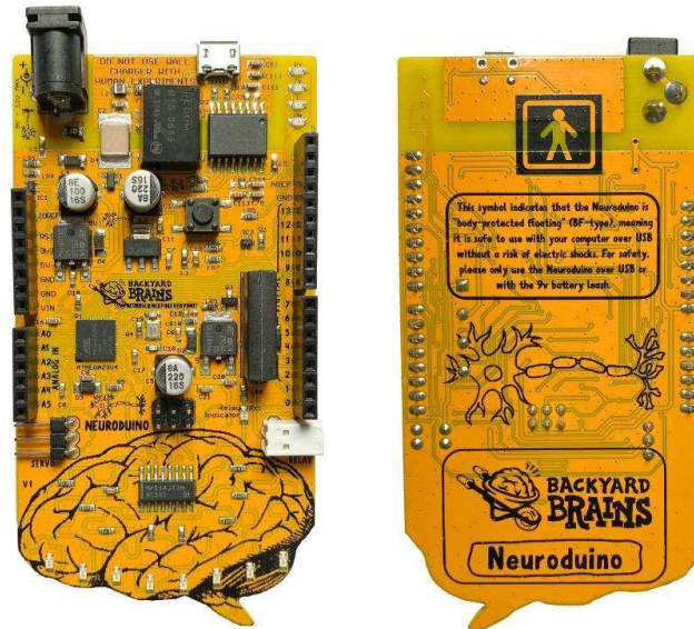
Figura 1.3: Neuroduino (Arduino modificado) para aplicações médicas.
