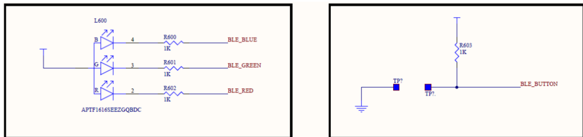
Figura 92 - Esquemáticos da interface contendo um LED RGB (Esquerda) e dois pontos para a solda de um botão externo (Direita) em modo pull-up .
