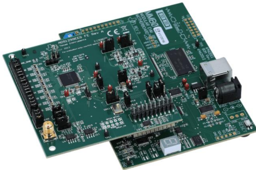
Figura 67 - Placa de avaliação do ADS1299, Texas Instruments. (TEXAS INSTRUMENTS, 2017b)
