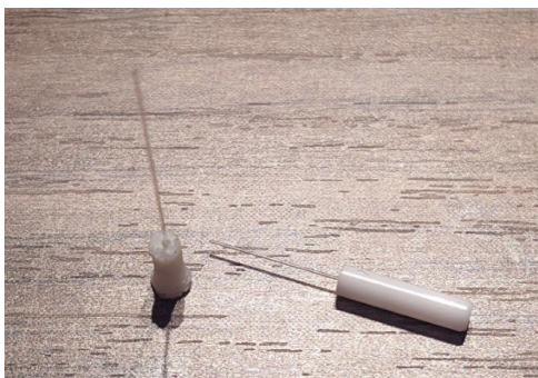
Figura 97 - Cânulas para construção do optrodo. Cânula impressa em 3D (Esquerda) e Cânula da fabricante pela THORLABs
