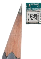
Figura 64 - Módulo Bluetooth BMD-350 da Rigado (Rigado, 2018)
