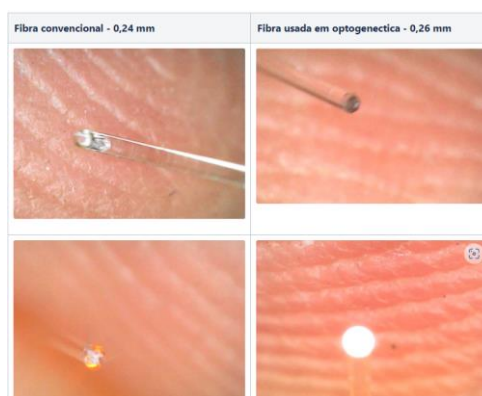
Figura 98 - Detalhes das pontas das fibras convencional e da usada na cânula da THORLABS.
