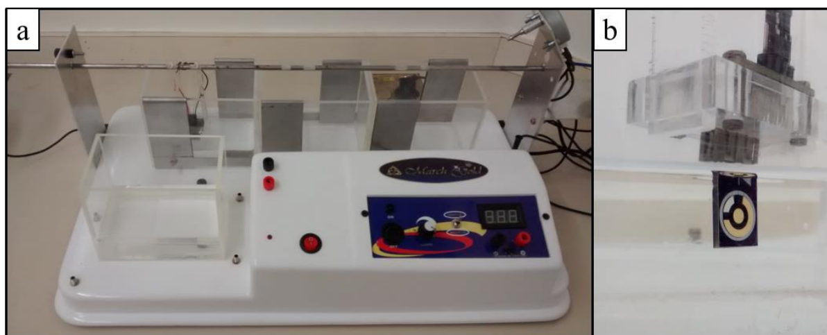
Figura 27 - Modificação dos eletrodos por Electroplating : (a) Sistema de deposição por electroplating ; (b) deposição dos eletrodos de referência, trabalho e auxiliar.
