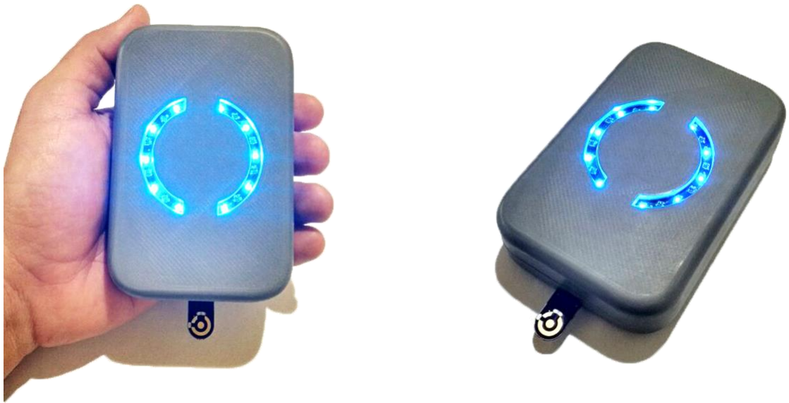
Figura 46 - Protótipo final desenvolvido e impresso por impressão 3D.
