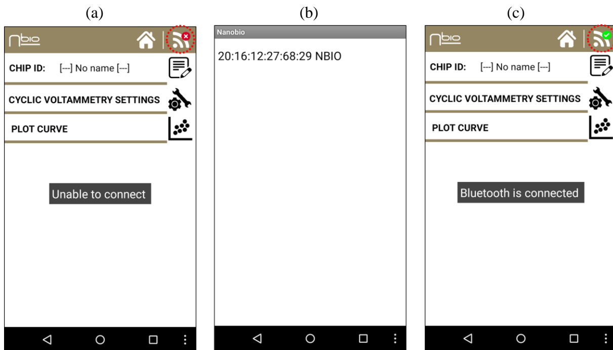
Figura 38 - Telas da interface com o usuário: (a) Telas sem conexão Bluetooth estabelecida, (b) lista de dispositivos próximos e (c) tela com a conexão estabelecida.
