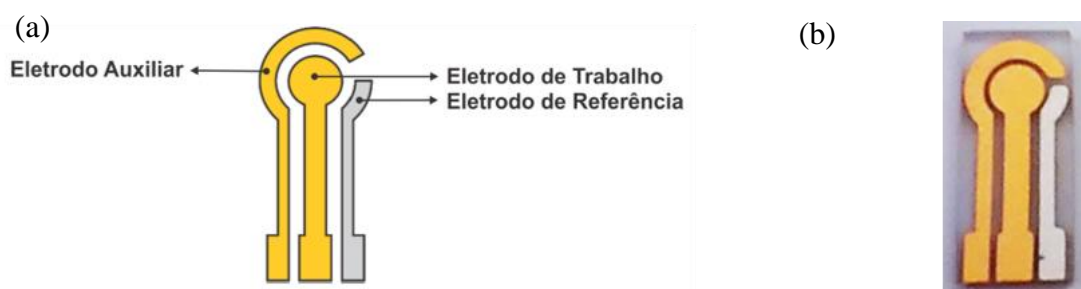
Figura 20 - Projeto e confecção dos sensores por Sputtering : (a) esboço do sensor projetado por software de desenho vetorial; (b) imagem real do sensor desenvolvido por Sputtering .
