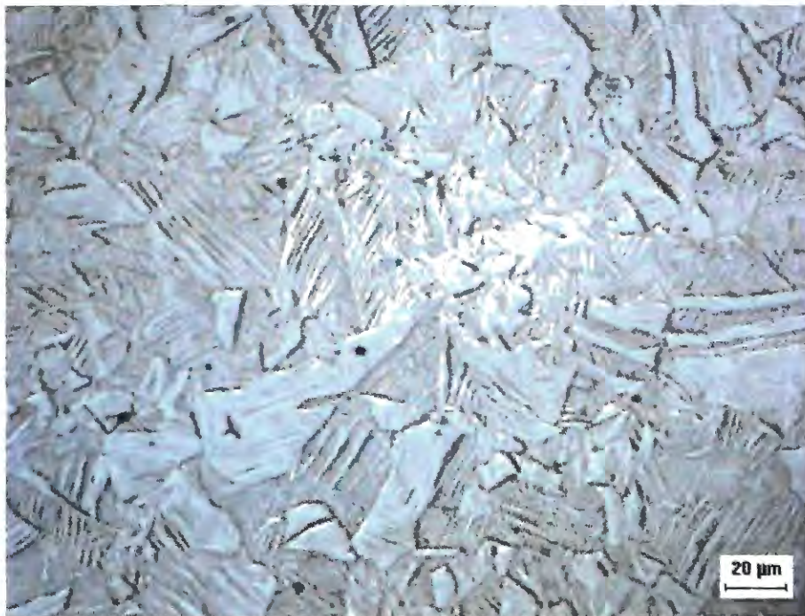
Figura 5.1 – Microestrutura do aço inoxidável austenítico AISI 316L após ataque com água régia
