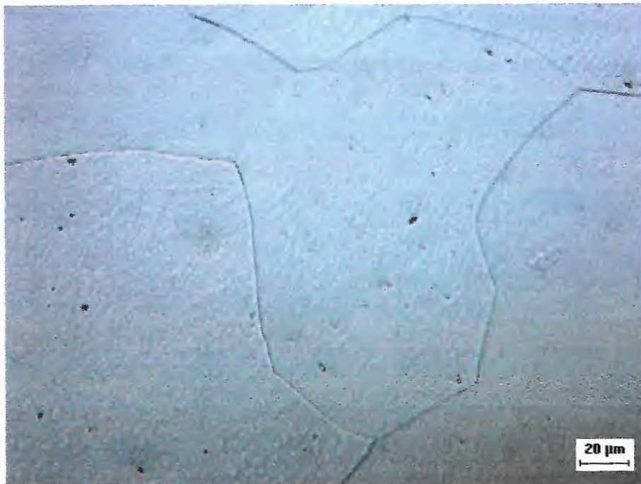
Figura 5.3 – Microestrutura do Ti-10Mo após ataque com reativo de Kroll
