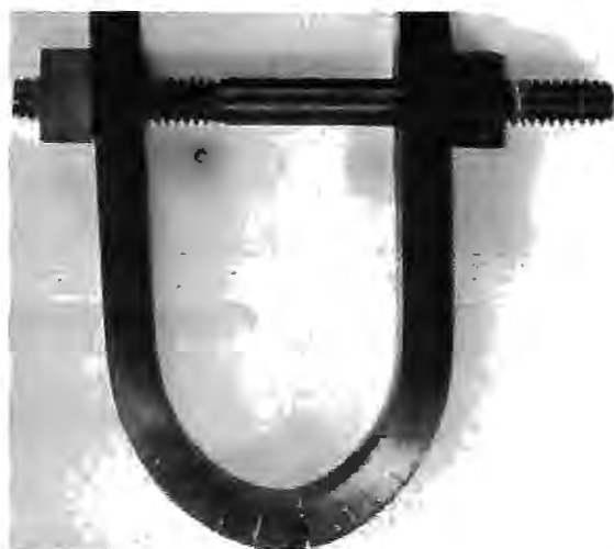
Figura 2.27: corrosão sob tensão em peça de aço dobrada em forma de U [Laqué,1975].
