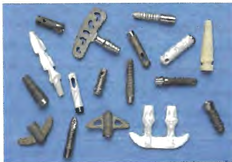
Figura 2.14 Principais geometrias e acabamentos superficiais de implantes disponíveis (SPIEKERMANN, 1995).
