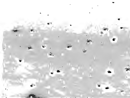
Figura 2.25: Corrosão por pite em aço inoxidável AISI 304 [Santos, 2002]
