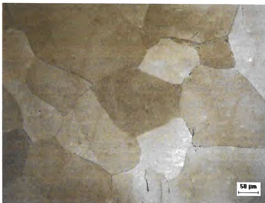
Figura 5.4 – Microestrutura do Ti-7,5Mo após ataque com reativo de Kroll
