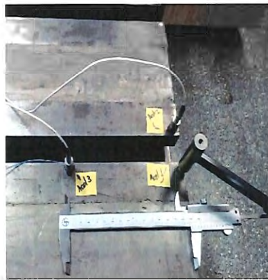
Figura 6.10: Avaliação da dinâmica da bancada de testes: (a) foto do arranjo experimental com 3 acelerômetros e martelo de impacto e (b) FRFs obtidas
