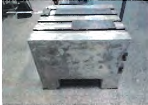
Figura 4.2: Bancada de testes composta por bloco de concreto e guias de aço para fixação com dimensões (1000x1000x820)mm.
