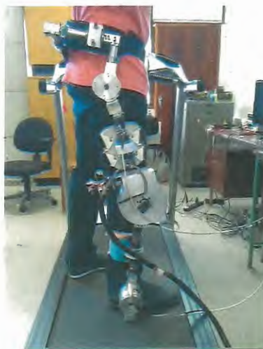
Figura 24: Encoders e rSEA ligados ao exoesqueleto modular de membros inferiores.
