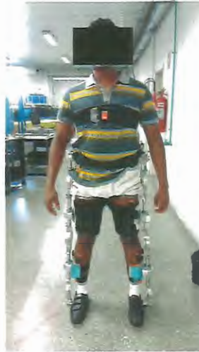
Figura 9: Configuração experimental, sensores IMU (laranja) e EMG (preto).
