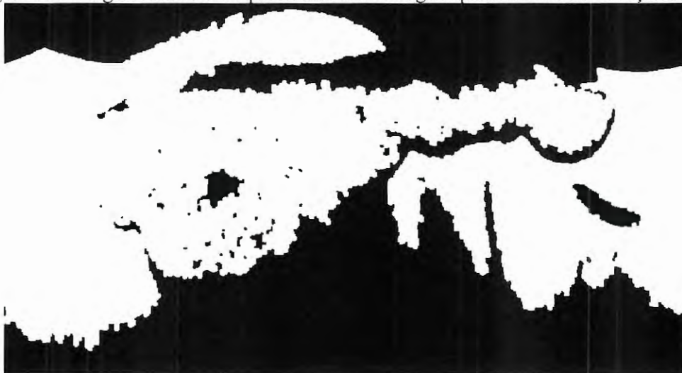
Figura 173: Imagem resultante do processamento de imagem que utiliza a transformação de cor YCrCb.
