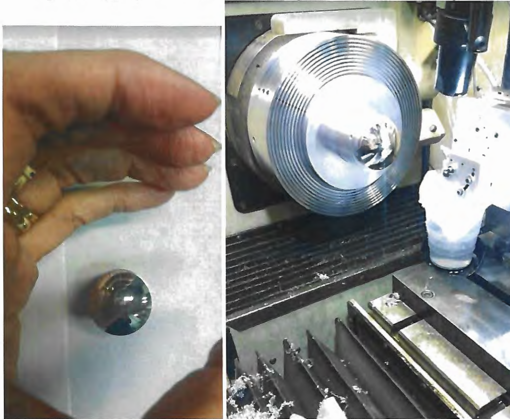
Figura 163: (a) Peça usinada em torno de ultra-precisão; (b) Peça em usinagem.
