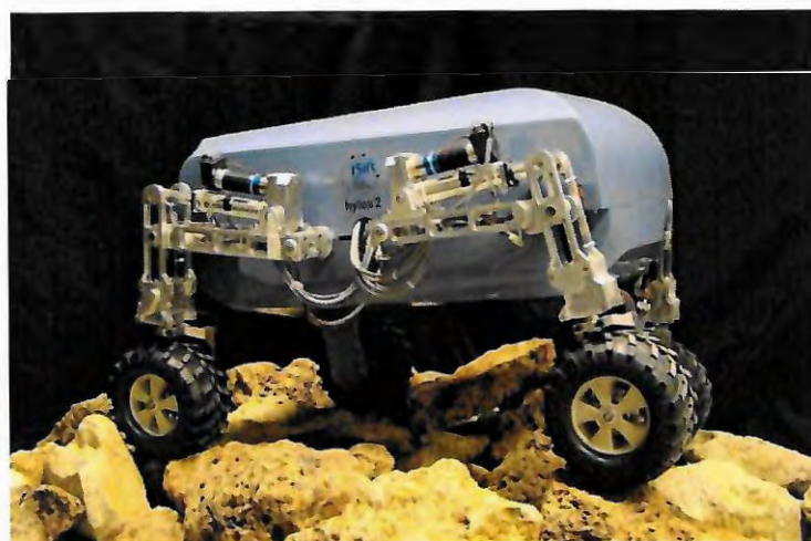
Figura 8 – Robô híbrido HyLoS2, dotado de quatro pernas e quatro rodas
