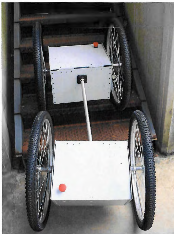
Figura 41 - Fotografia da plataforma real subindo uma escada
