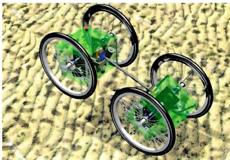
Figura 1- Ilustração artística, desenvolvida no software SolidWorks, da plataforma proposta de quatro rodas motrizes
