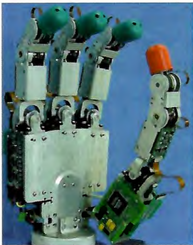
Figura 2. 8 – DLR HIT-HAND (sem cobertura)
