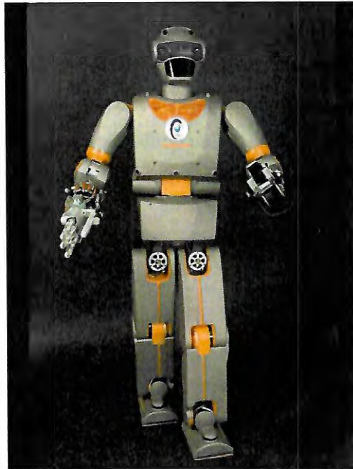
Figura 2.4 – O robô de serviço REEM-B
