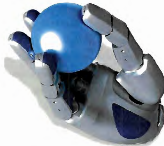
Figura 2. 9 – DLR HIT-HAND (com cobertura)
