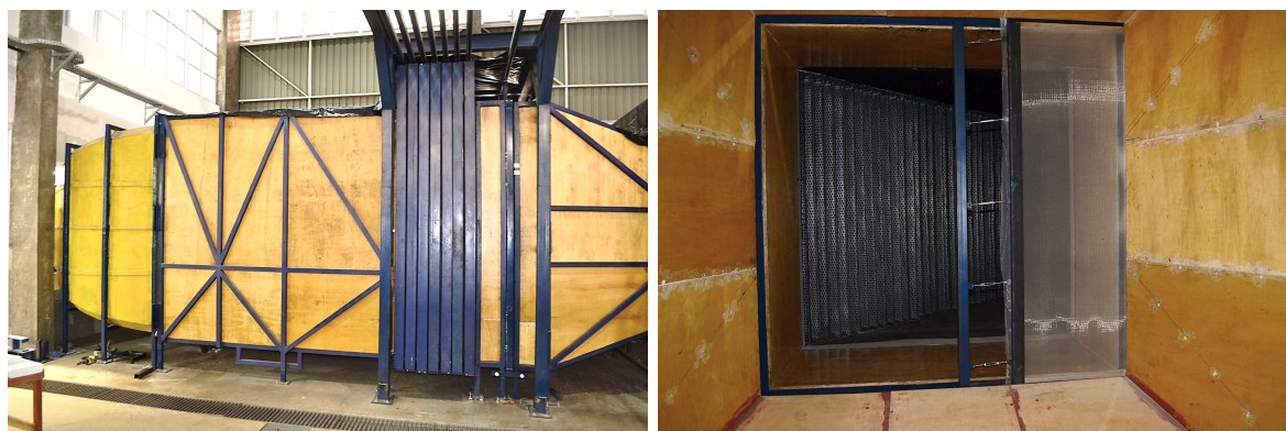
(a) Da esquerda para a direita: contração, câmara de estabilização, telas, colmeia e difusor de grande ângulo (b) Detalhe da tela parcialmente aberta em fotografia tirada a partir do difusor de grande ângulo
