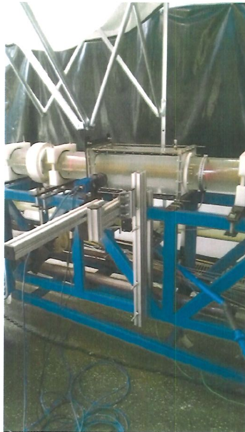
Figura 4.12. Posicionamento da câmera do PIV para obtenção das imagens.
