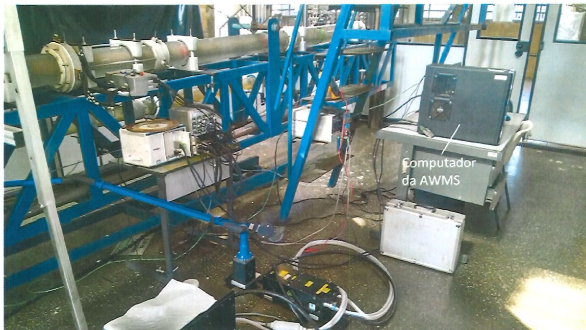
Figura 4.15. Equipamentos da AWMS e do PIV no duto anular.
