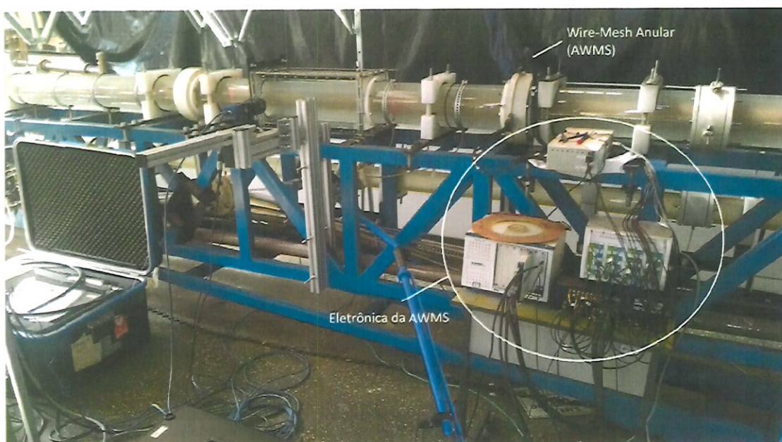
Figura 4.14. Equipamentos ligados à AWMS no duto anular.
