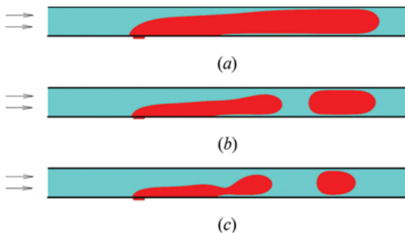
Figura 9 – Simulação de escoamento com mudança de fase em canal bidimensional com diferentes números de Reynolds: (a) Re = 0.27 ; (b) Re = 0.396 ; (c) Re = 0.468 .
