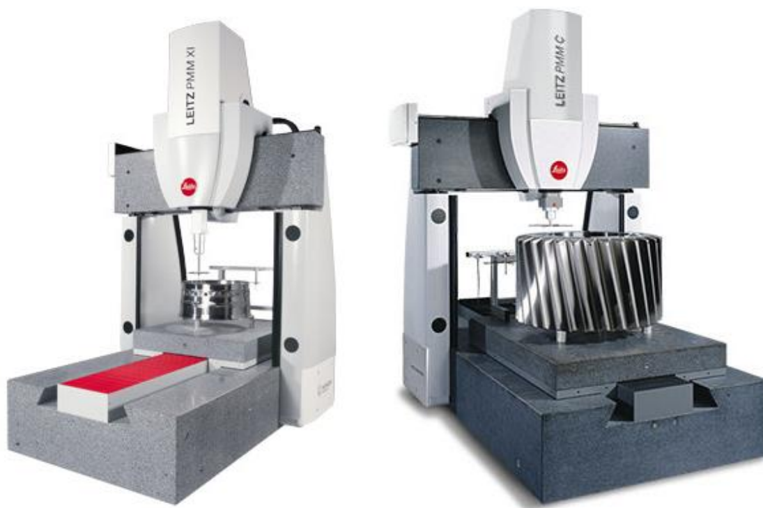
Figura 3 - MMC do tipo ponte fixa. Fonte: Hexagon Metrology (2016)
