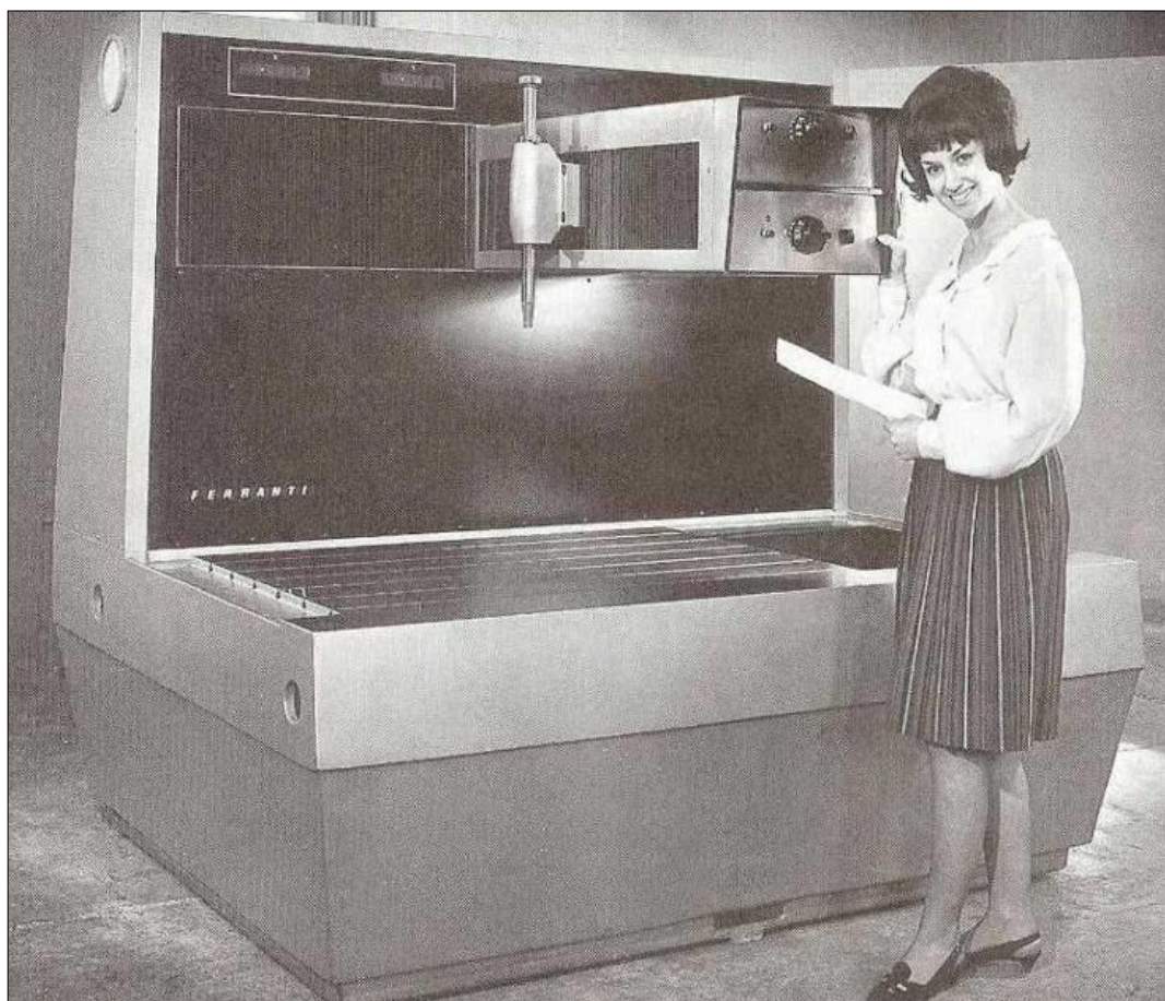
Figura 1 - Primeira MMC fabricada por Ferranti Ltd em 1956 Fonte: Bosch (1995).
