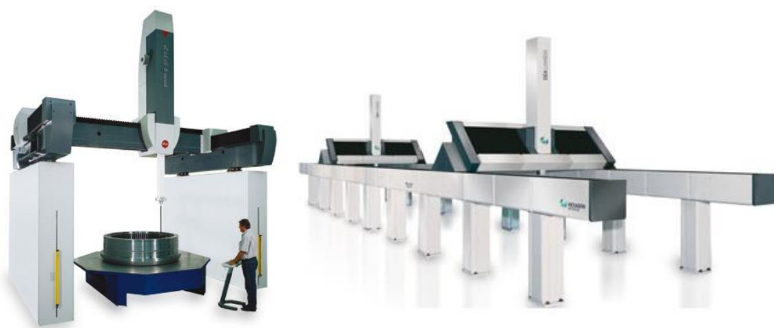
Figura 6 - MMC do tipo pórtico. Fonte: Hexagon Metrology (2016)
