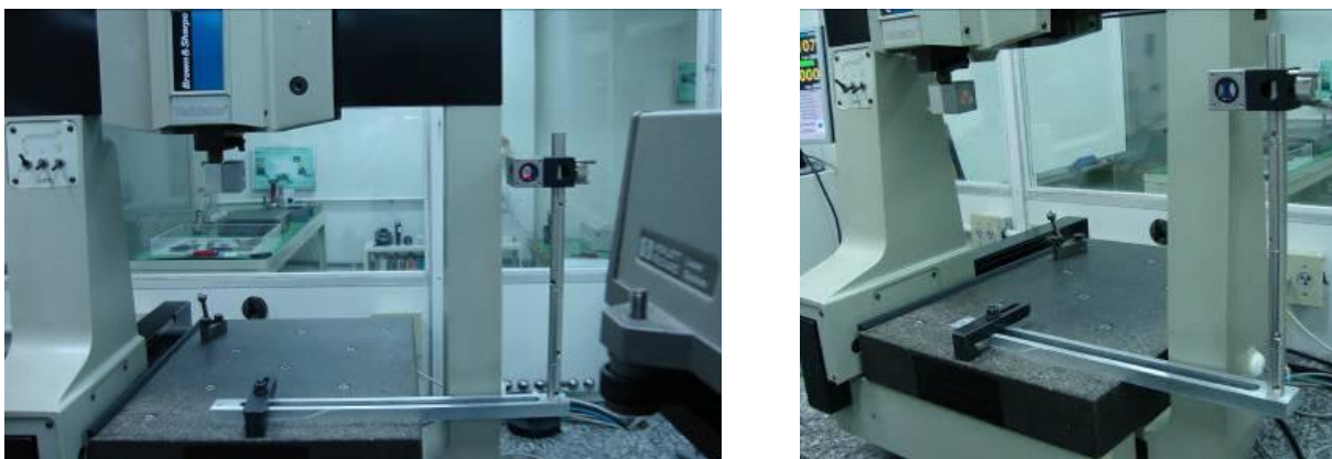
Figura 5. 5: Montagem utilizada para calibração da escala X.
