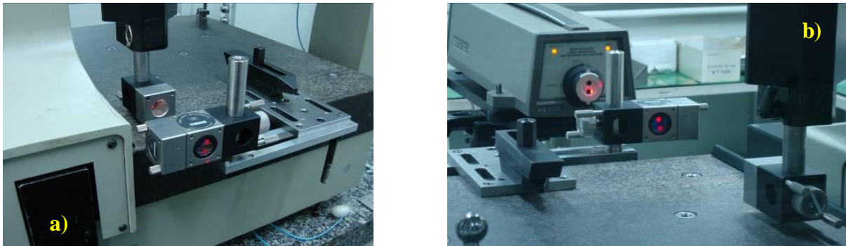
Figura 5. 4: Visão frontal (a) e traseira (b) da montagem utilizada para calibração da escala Y.
