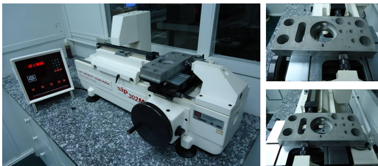
Figura 5. 19: Medição da distância entre paredes com a SIP em ambiente com temperatura e umidade controladas.
