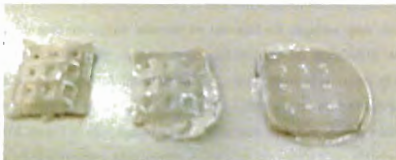
Figura 26 – Peças com impressão de apenas uma camada mostrando o espalhamento da polimerização com o aumento do tempo de exposição a luz
