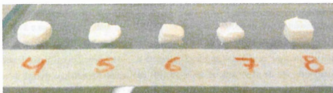
Figura 37 – Primeiros componentes cerâmicos fabricados sem o filtro UV no projetor de imagens
