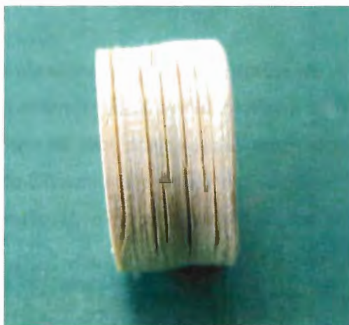
Figura 33 – Aspecto do componente cerâmico após sinterização
