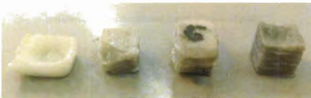
Figura 25 – Primeiras peças fabricadas apresentando a evolução com o ajuste dos parâmetros de construção das camadas.
