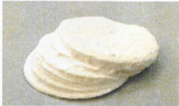
Figura 34 – Componente fabricado apresentando escorregamento de camadas
