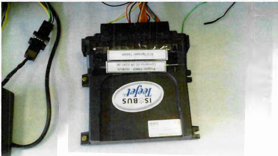
Figura 21: ECU do Pulverizador IC18 TeeJet (Fonte: o autor).
