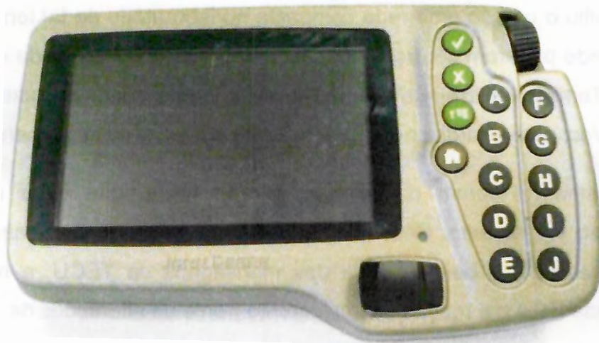
Figura 20 : Terminal virtual John Deere Greenstar 1800 (Fonte: o autor).
