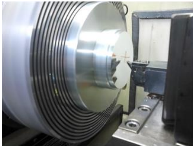
Figura 7 Faceamento de peça no torno de ultra precisão Rank Pneumo ASG 2500
