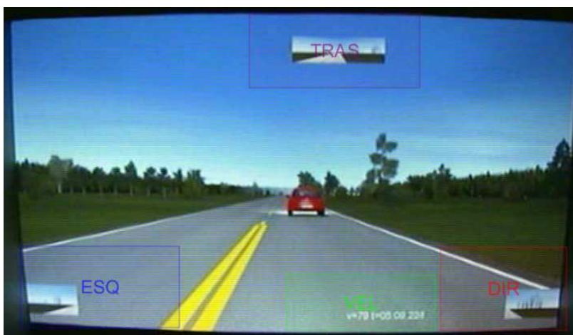
Figura 46 – Regiões de interesse para verificação de fixações.
