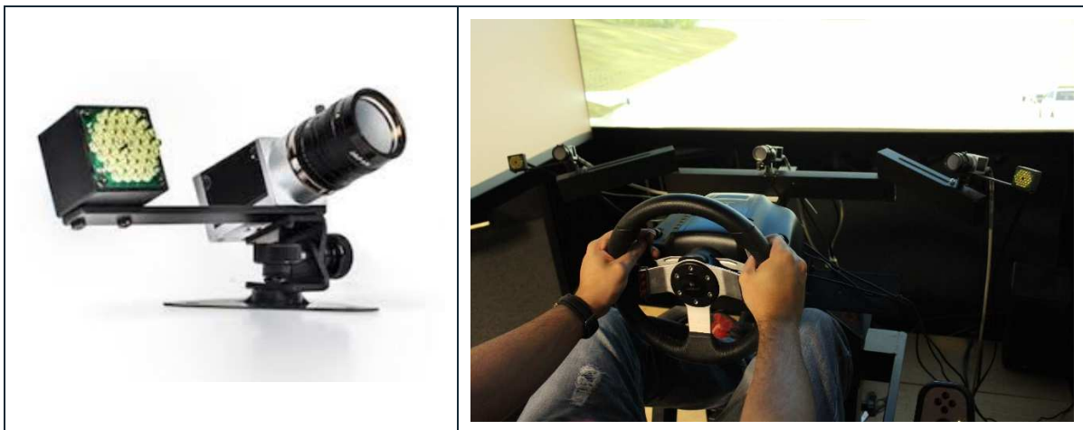
Figura 17 – Detalhe da câmera do SmartEye e disposição das câmeras no simulador.
